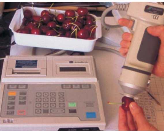
Figura 2. Medidor de color Minolta CR-200
