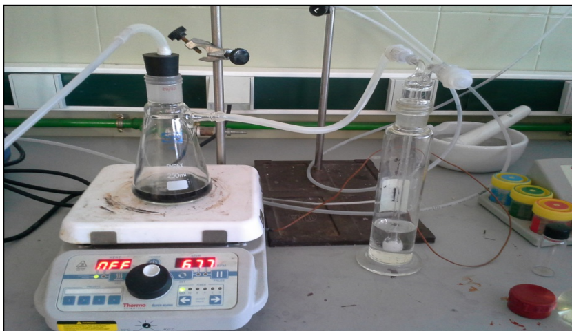
Figura 5. Dispositivo kitasato más borboteador para la detección y captura del CO 2 .
