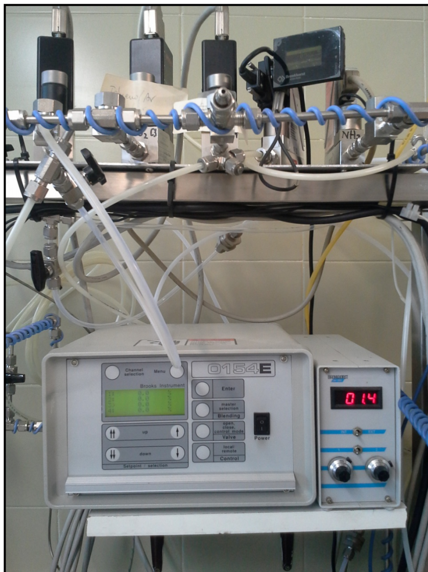
Figura 4. Sistema de control de flujo de gas.
