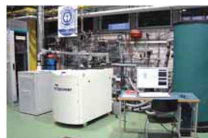
Abb. 6: BHKW-Prüfstand an der Hochschule Reutlingen
