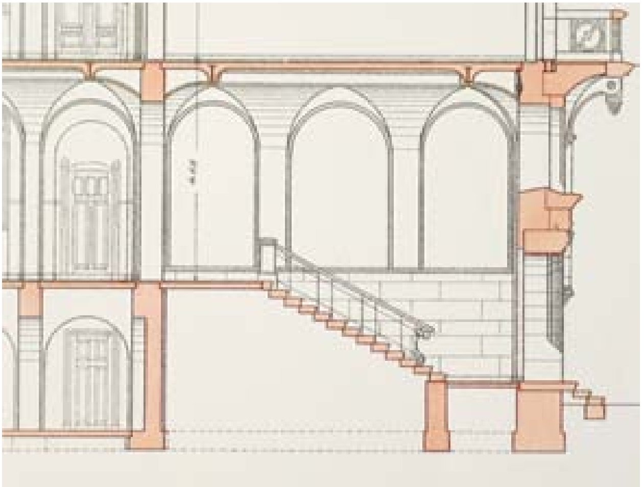
Abb. 171a und b: Schnitt durch den Haupteingang mit Balkon, Blick in Richtung Schulstraße. (Lithographie der Bauzeichnung, Archiv TU)
