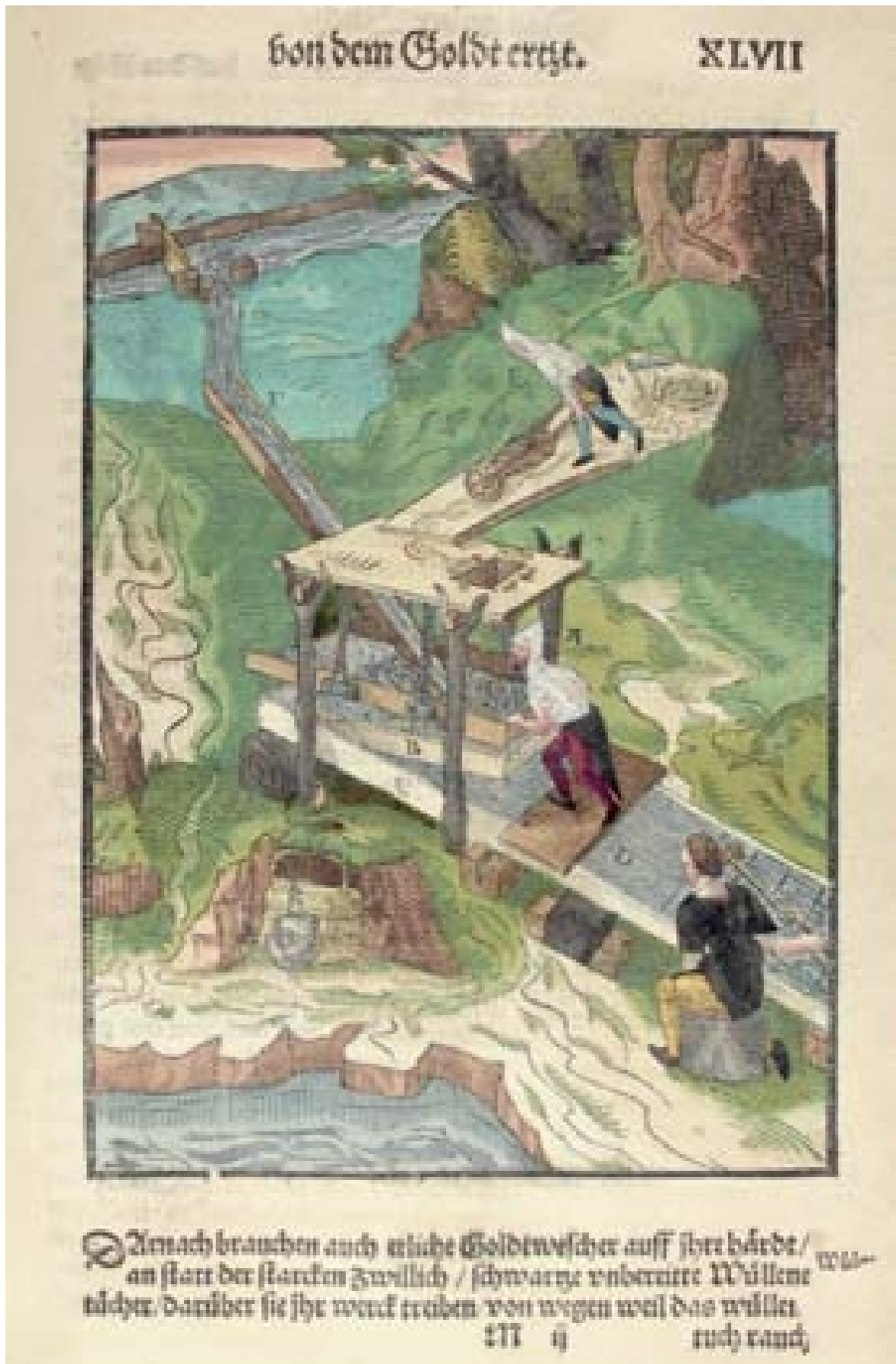
Abb. 15: Erzaufbereitung: Sieben und Waschen des aus einer naheliegenden Schurfstelle gewonnenen Materials. (Lazarus Ercker, 1528-1594, DAS GROSSE PROBIERBUCH, Ausgabe Frankfurt 1672/73)
