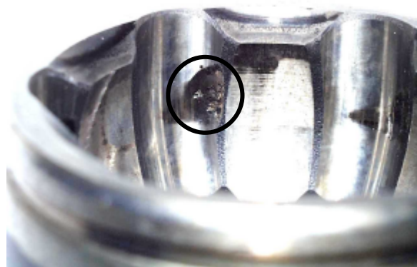
Bild 4: Pitting auf den Kugellaufbahnen im Gelenkstück nach ca. 3 Mio. Lastwechseln
