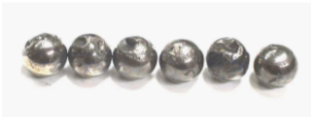
Bild 6: Extrem beschädigte Kugeln nach einer Lastwechselzahl von ca. 23 Mio.
