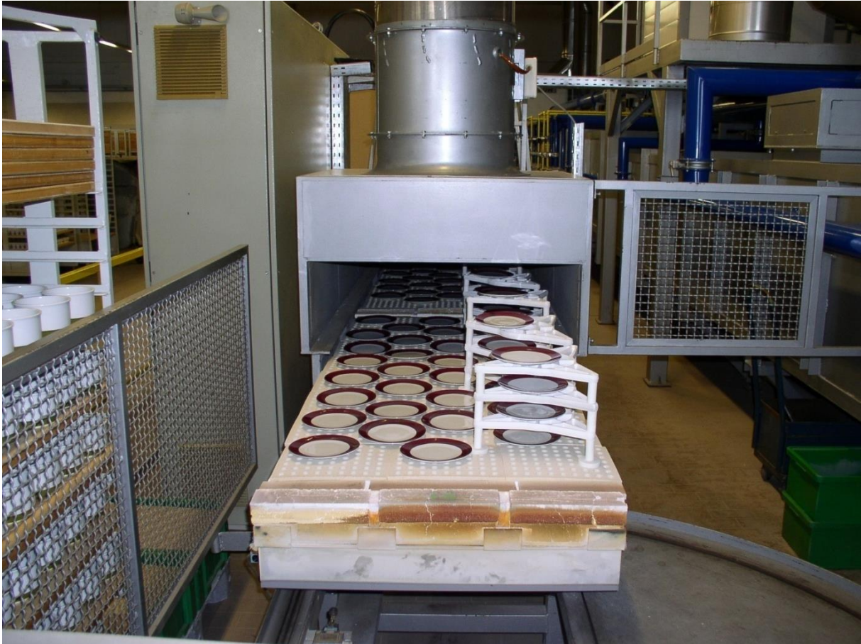
Abb. 6.2.7: Brennen von keramischen Dekoren.
