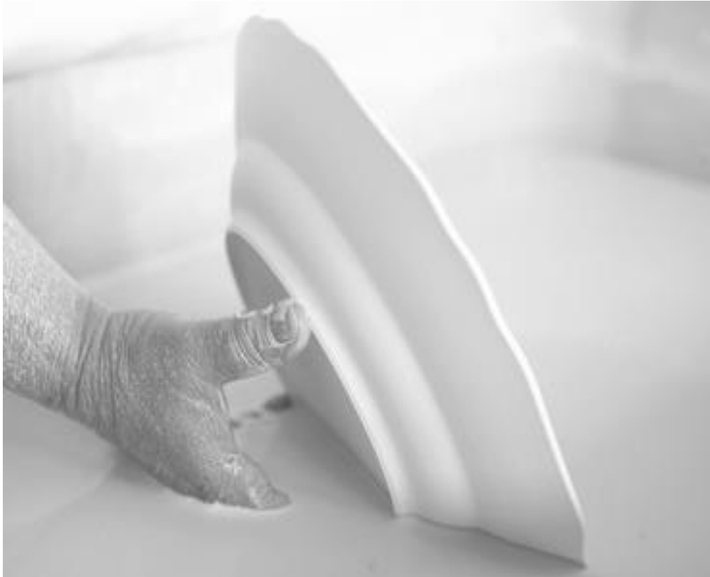
Abb. 6.1.1: Manuelles Tauglasieren von Zierporzellan in einer Glasurwälzwanne.
