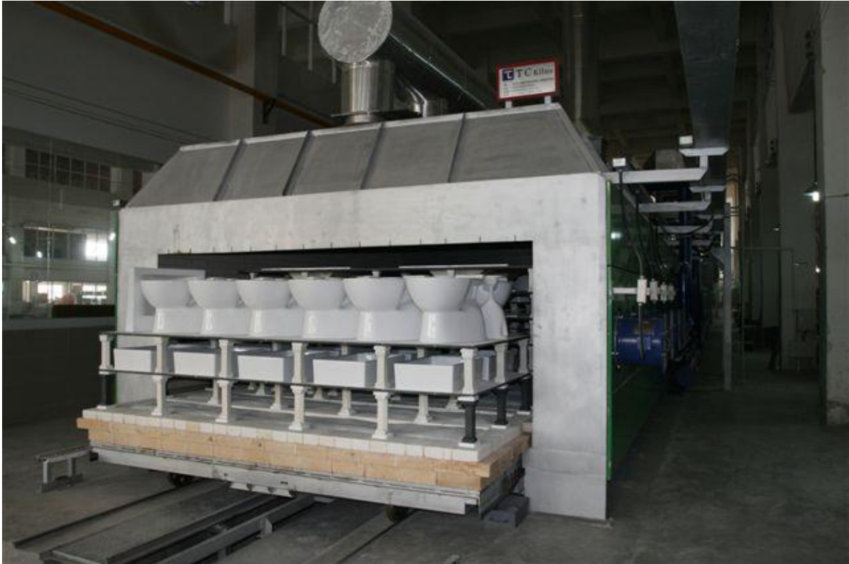
Abb. 5.2.1.9: Ofenanlage für Sanitärkeramik – Mehreretagen-Tunnelofen.
