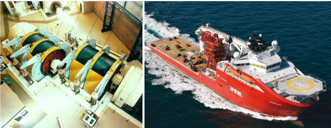
Abbildung 1: Blair Multi-Rope Double-Drum Winder im Bergbau (links) [Reb11]; Offshore Construction Vessel „Skandi Acergy“ (rechts) [Sub12]
