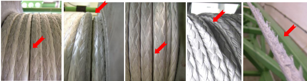
Abbildung 13: Zu beobachtende makroskopische Phänomene am Teilsystem Faserseil im Zuge der Mehrlagenwicklung
