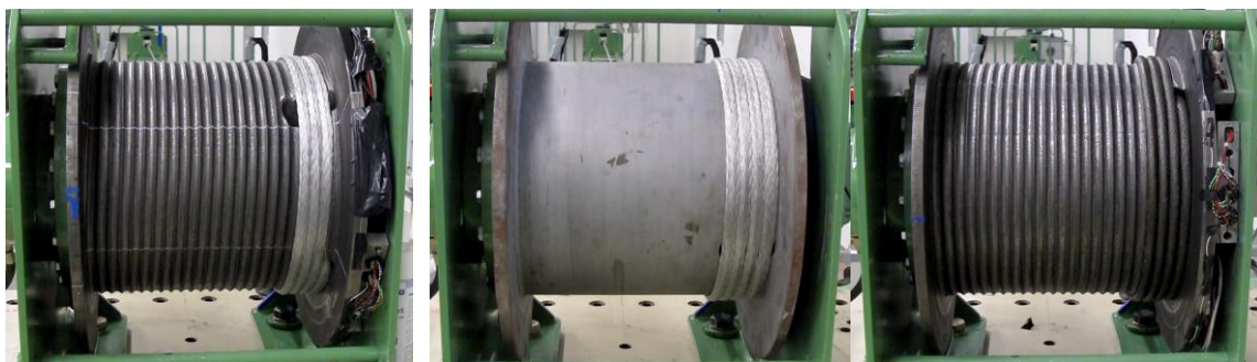
Abbildung 6: Untersuchte Seil- und Trommelvariationen – Faserseil berillt sowie unberillt, Drahtseil berillt
