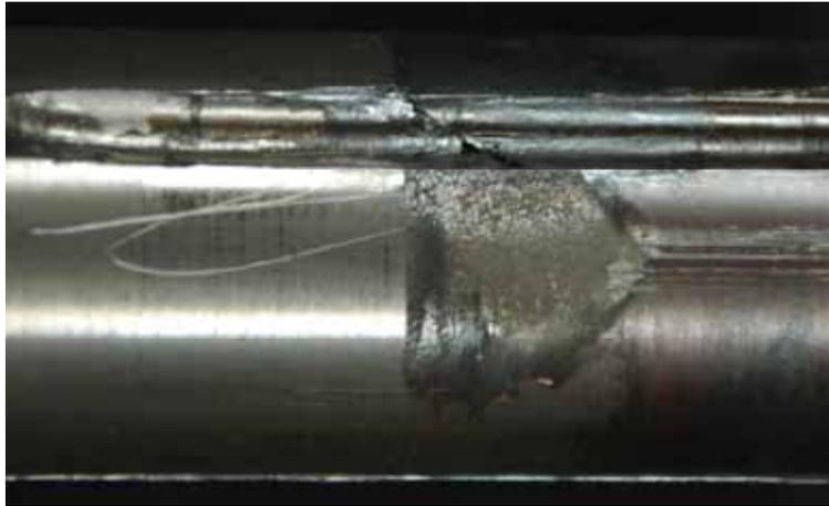
**Bild 6:** Torsionsbruch an Probe Geometrie 4
