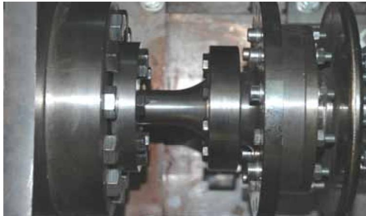
**Bild 4:** Einspannsituation im Torsionsschwingprüfstand
