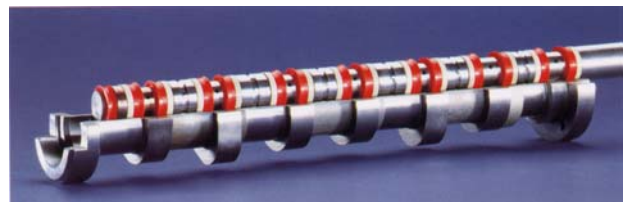
Bild 2: Sonde zum Fügen einer Nockenwelle, /4/
