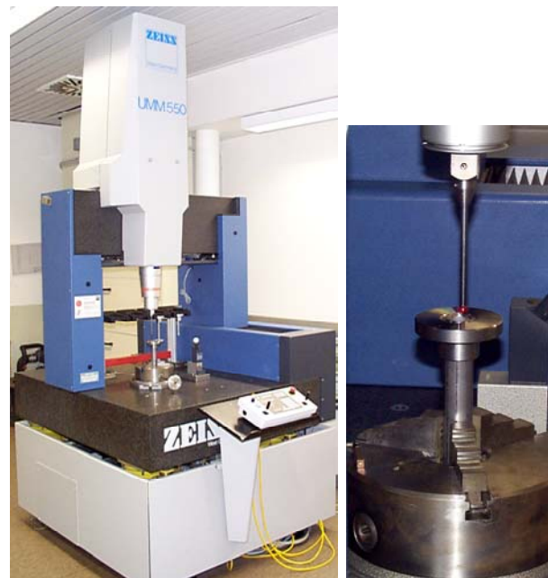
Bild 5: Messung der IHF-Prüflinge mit der 3-D-Koordinatenmessanlage UMM 550 der Fa. Zeiss
