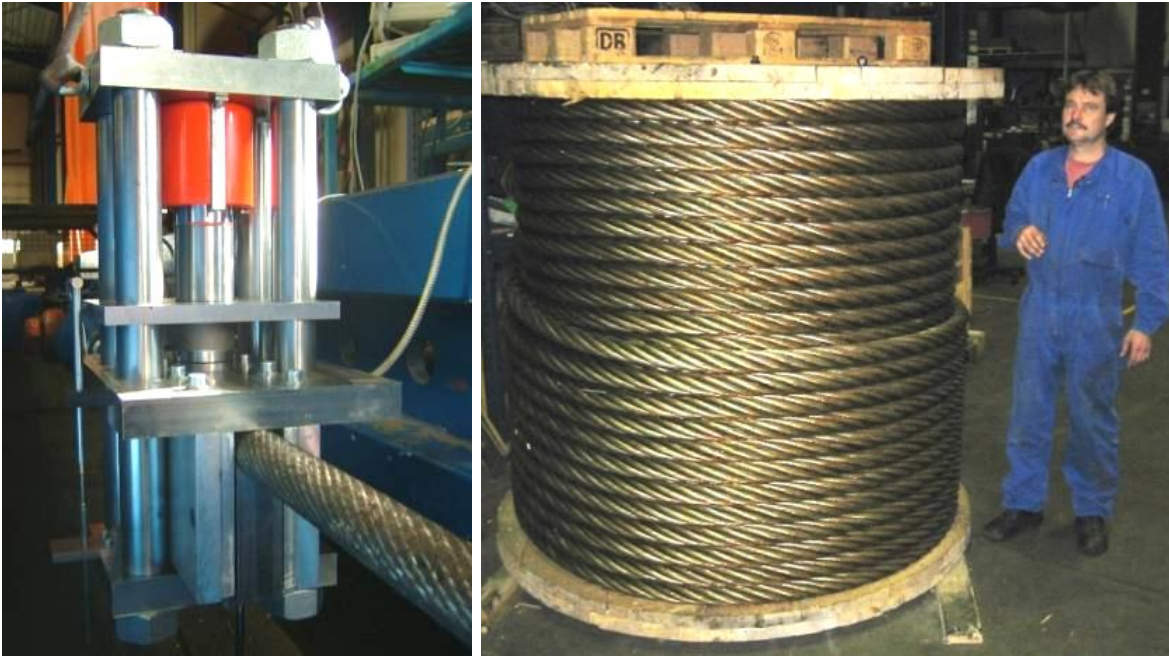
Abbildung 21: Mobiles Querprüfgerät für große Seilennendurchmesser im Einsatz
