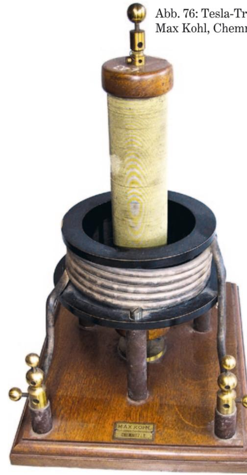
Abb. 76: Tesla-Transformator. Max Kohl, Chemnitz, 1896.
