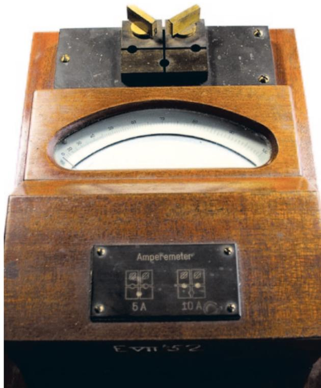
Abb. 63: Präzisions-Volt- und Ampèremeter für Gleichstrom. Siemens & Halske, 1912.
