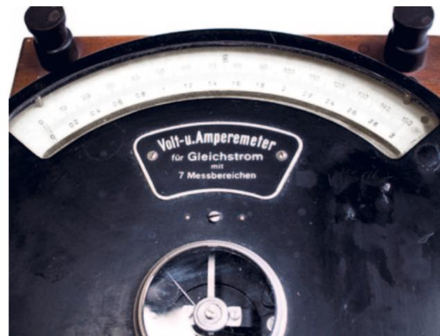
Abb. 65: Volt- und Ampèremeter für Gleichstrom mit sieben Meßbereichen. Siemens & Halske, 1914.
