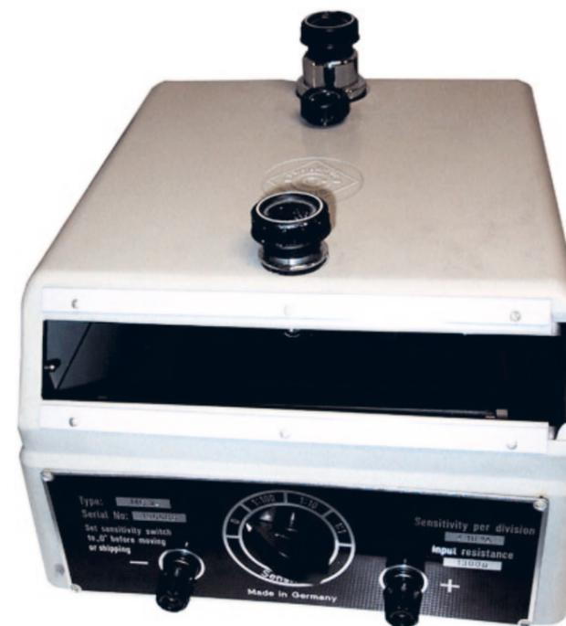
Abb. 51: Lichtzeiger-Galvanometer. Empfindlichkeit  $4 \cdot 10^{-9} \text{ A/Skalenteil}$ . Firma Lange.
