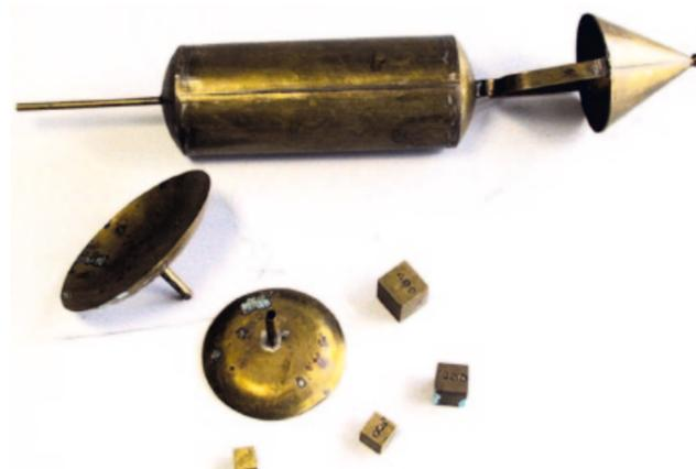
Abb. 12: Aräometer zur Dichtebestimmung von Flüssigkeiten – Schwimmkörper mit Waagschalen und Zusatzgewichten.
