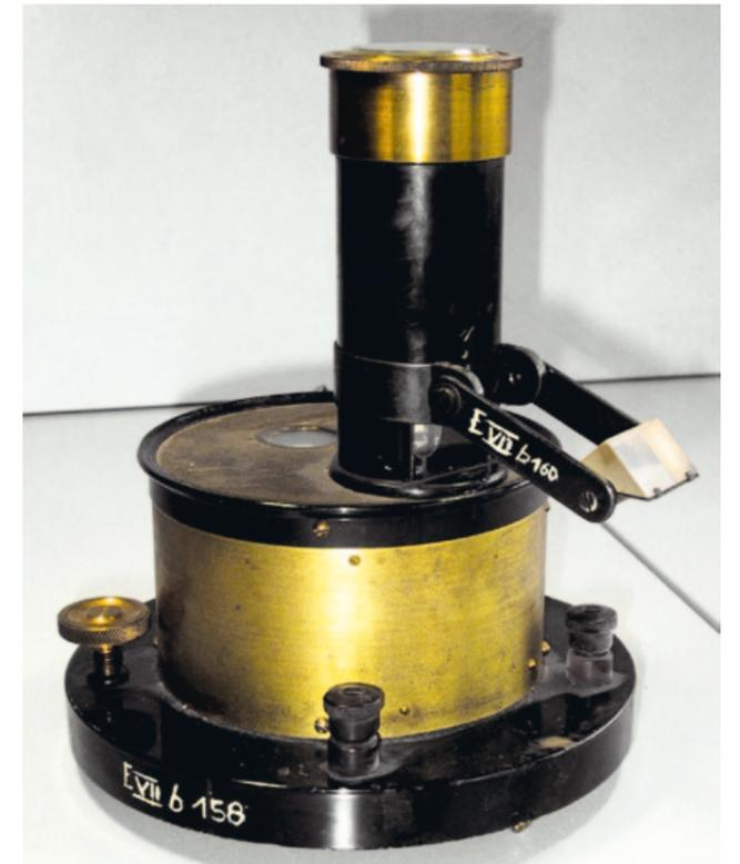
Abb. 50: Kriechgalvanometer (Hartmann und Braun, etwa 1947) und äußerlich baugleiches Drehspul-Spiegel-Galvanometer,  $R = 2600 \Omega$  (Hartmann und Braun, 1927).
