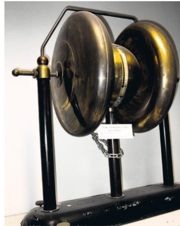
Abb. 79: Kugel-Kilovoltmeter nach Dr. Sterzel (150 kV). 1924.
