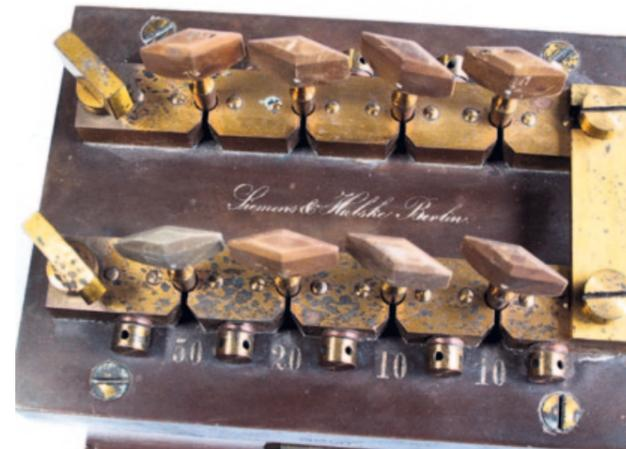
Abb. 68: Stöpselrheostat 1-50  $\Omega$ , Widerstandskette - Neusilber, richtig bei 20 °C. Siemens & Halske, Berlin, 1883.
