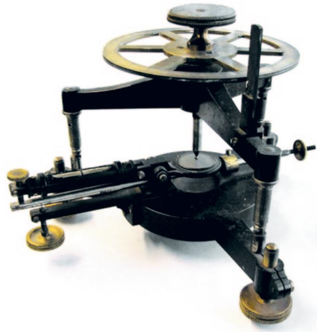
Abb. 1: Dickenmesser mit Mikrometer für Platten und Bleche, 0–30 mm, Auflösung  $\frac{1}{1000}$  mm. Die Probe liegt auf einem Waagearm mit Libelle, der für konstanten Andruck durch die Tastspitze sorgt. F. W. Breithaupt & Sohn, Cassel.
