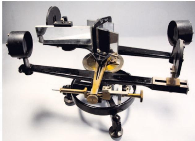
Abb. 91: Infrarot-Spiegelspektrometer nach Rubens. Firma Schmidt und Haensch, Berlin, 1916.
