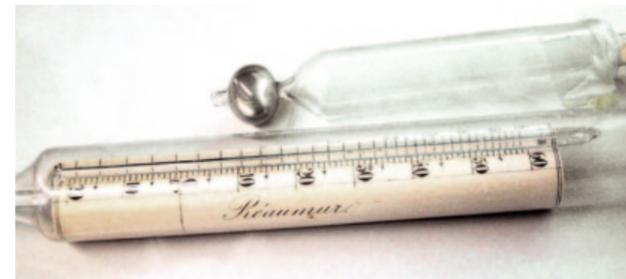
Abb. 19: Ältere Temperaturskala in Réaumur.
