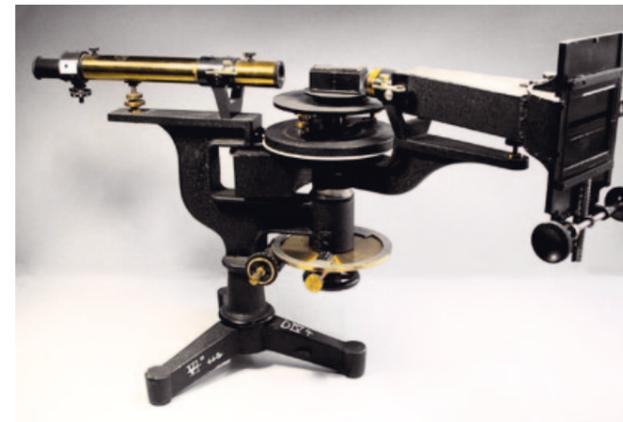
Abb. 86: Spektralapparat mit Rutherford-Prisma. Carl Zeiss, Jena, Nr. 6767.
