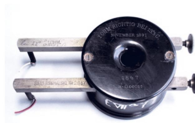
Abb. 69: Widerstandsnormal 1  $\Omega$  - richtig bei 13,5 °C,  $\alpha = 0,00015$ . No 2847, November 1891.
