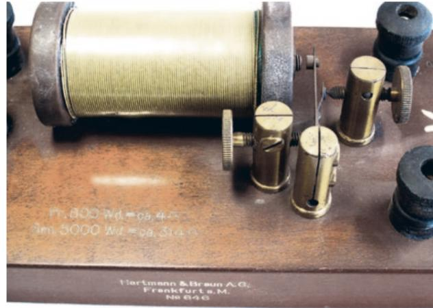
Abb. 72a und 72b: Induktionsapparat zur Walzenmeßbrücke. Primär 800 Wicklungen mit ca. 4 Ω, sekundär 5000 Wicklungen, ca. 314 Ω. Hartmann & Braun, Nr. 646, 1922.
