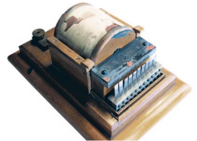
Abb. 67: Elektrischer Zungenfrequenzmesser, 44-64 Hertz.
