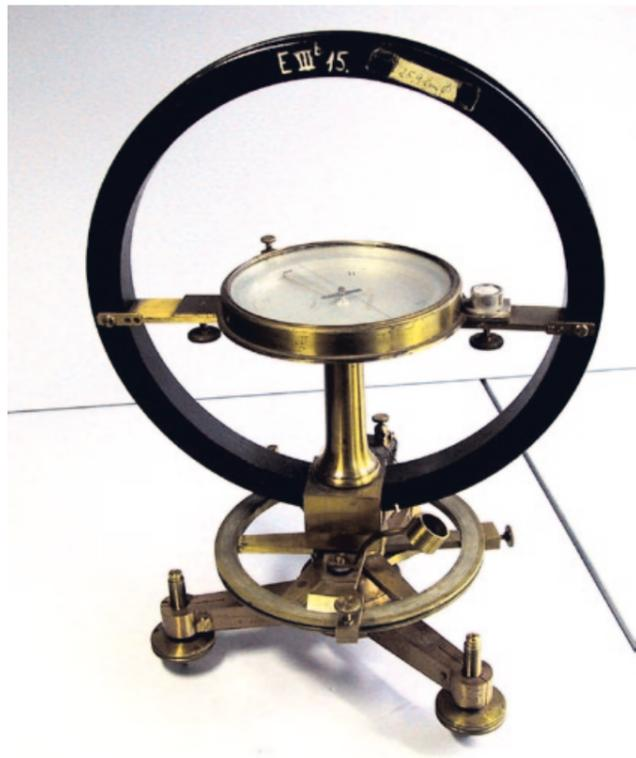
Abb. 23: Tangentenbussole. Eine kleine Kompaßnadel ruht drehbar auf einer Spitze in einer Drahtspule aus mehreren Windungen. Zwei dünne Zeigespitzen sind senkrecht zur Nadel an dieser befestigt.
