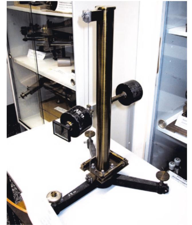
Abb. 18a und 18b: Horizontalpendel, Seismometer. Eine Masse, versehen mit einem Spiegel für einen Lichtzeiger (links), hängt an zwei gespannten Drähten. Bei Erschütterungen am Stativ kann sie sich bewegen. Mit drei empfindlichen Libellen und Justierschrauben läßt sich der Fuß horizontieren.
