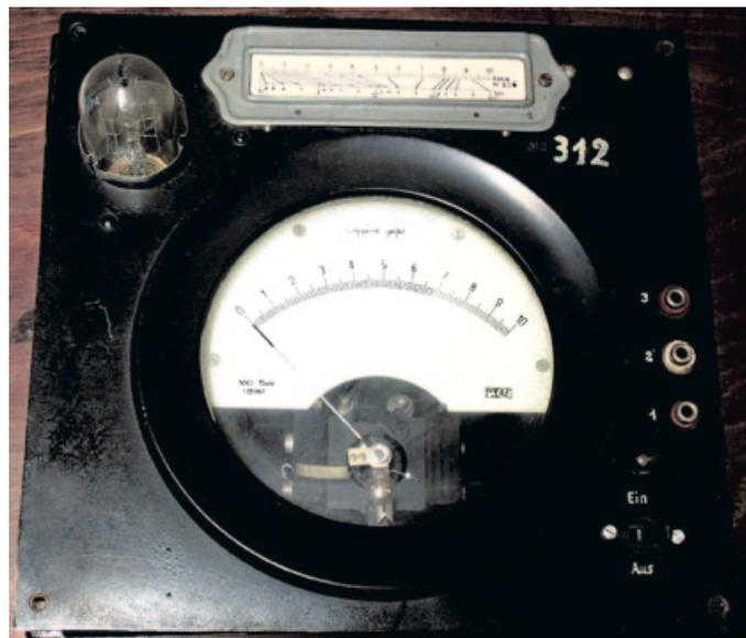
Abb. 102: Röhrenverstärker mit Anzeige für ein Vakuummeßgerät, oben eine Umrechnung für Anzeige-Druck.
