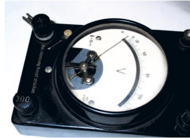
Abb. 66: Weicheisen-Instrument. Gossen.
