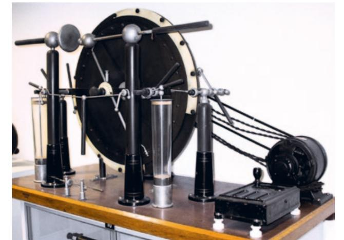
Abb. 78a und 78b: Influenzmaschine.
