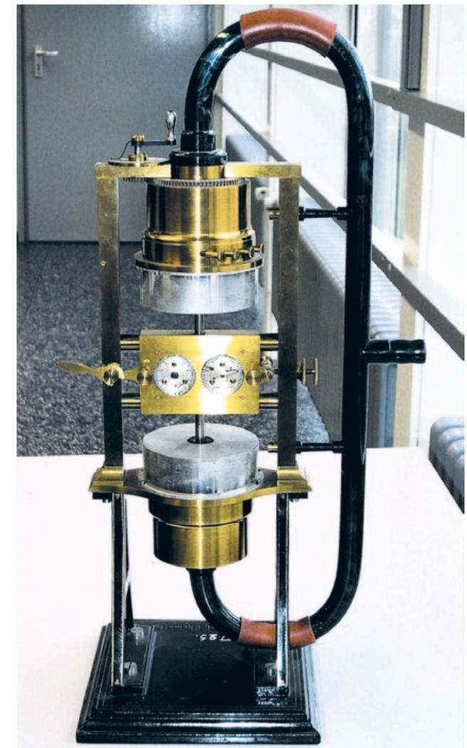
Abb. 98a und 98b: Doppelsirene nach Helmholtz – erzeugt acht Töne unterschiedlicher Frequenz und Phasenlage. Über ein Untersetzungsgetriebe mit Zählwerk zusammen mit einer elektrisch schaltbaren Stoppuhr kann die Frequenz der Töne präzise gemessen werden. Max Kohl, Chemnitz, 1894.
