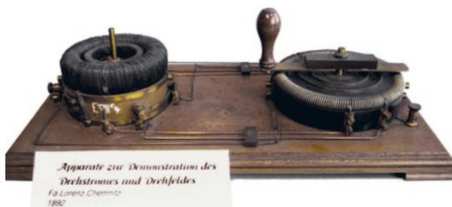
Abb. 74: Apparat zur Demonstration eines Drehfeldes. Firma Lorenz, Chemnitz, 1892.
