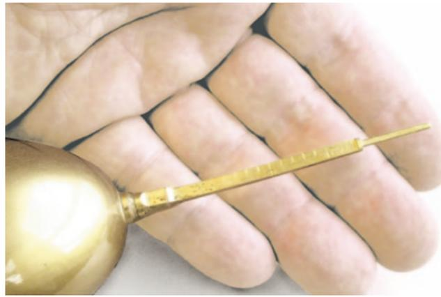
Abb. 11: Aräometer, Senkwaage zur Dichtebestimmung von Flüssigkeiten – Oberteil des Schwimmkörpers mit Skala. Vor 1920.
