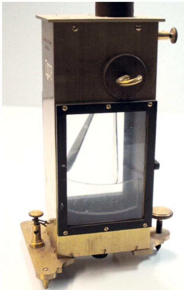
Abb. 55: Elektrometer. Gleichsinnig elektrisch geladene Platten stoßen einander ab. Die Kraft zwischen den Platten ist ein Maß für die elektrische Spannung. E. Leybold's Nachfolger, Coeln-Rhein.
