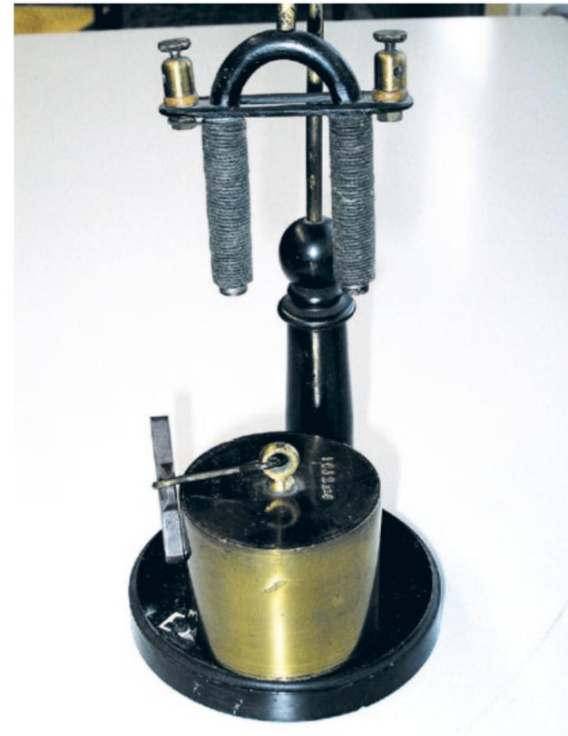
Abb. 25: Elektromagnet mit Gewicht. Die Beschriftung auf dem Gewicht »1 kg« und »7 Mark« gibt die Umrechnung zwischen dem alten Gewicht Mark und dem heutigen Kilogramm: 1 Mark = 0,236 kg.
