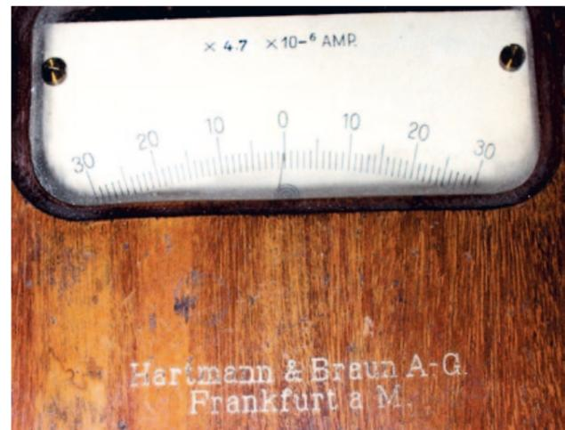
Abb. 64: Drehspulinstrument.  $4,7 \cdot 10^{-6}$  A/Skalenteil Empfindlichkeit. Hartmann & Braun.
