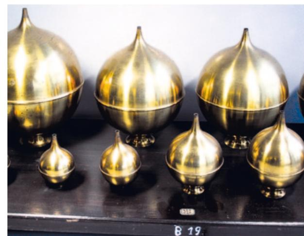
Abb. 97a und 97b: Resonatoren nach Helmholtz.
