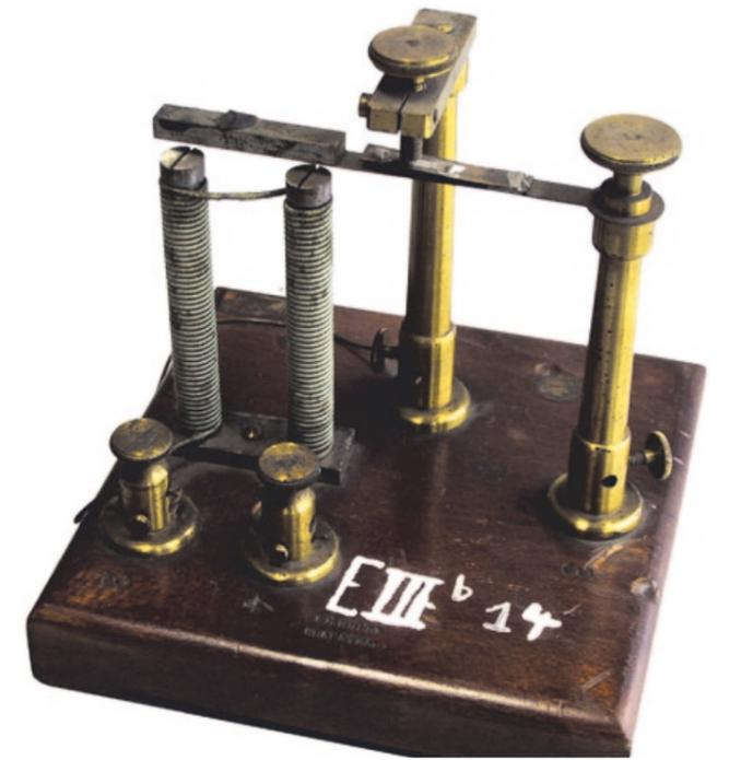
Abb. 26: Galvanischer Unterbrecher (Wagnerscher Hammer). 1876.
