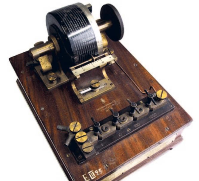
Abb. 71: Präzisionsschleifring-Widerstand, Walzenmeßbrücke. Hartmann & Braun, No 909, 1929.
