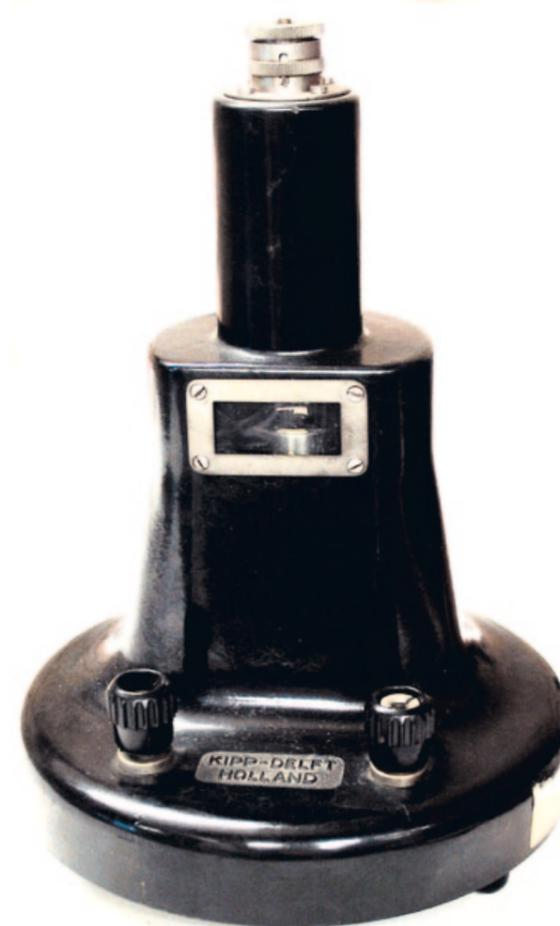
Abb. 49: Galvanometer – robust gekapseltes Drehspulmeßwerk mit Spiegel für einen Lichtzeiger. Kipp-Delft.
