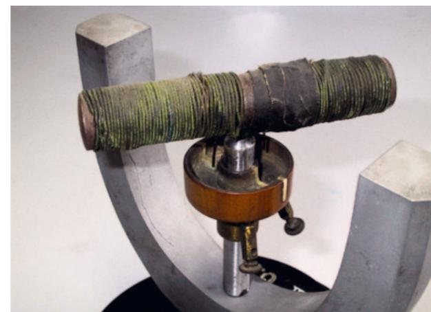
Abb. 28: Elektromagnetische Rotationsmaschine nach Ritchie – Motor mit Quecksilberschleifring. 1886.
