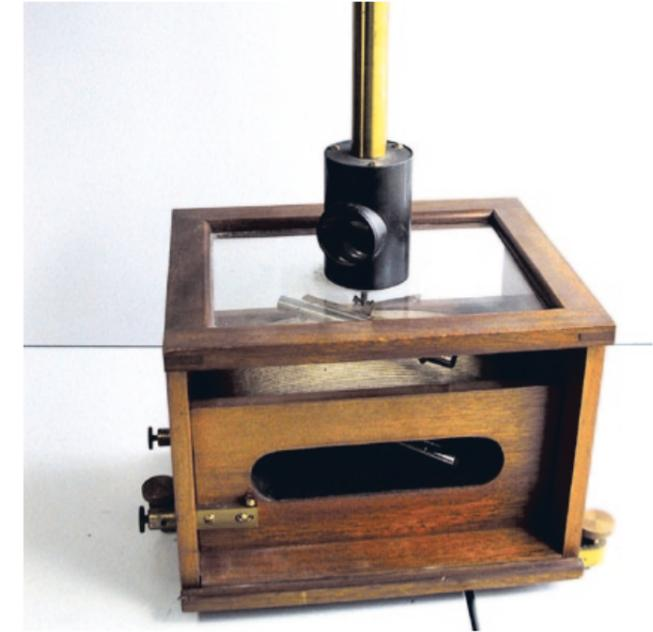
Abb. 42: Astaticsches Galvanometer für Erdinduktor mit Spiegel für Lichtzeiger. Deutlich sichtbar sind die beiden (dicken) Magnetnadeln. Georg Bartels, Göttingen, 1911.
