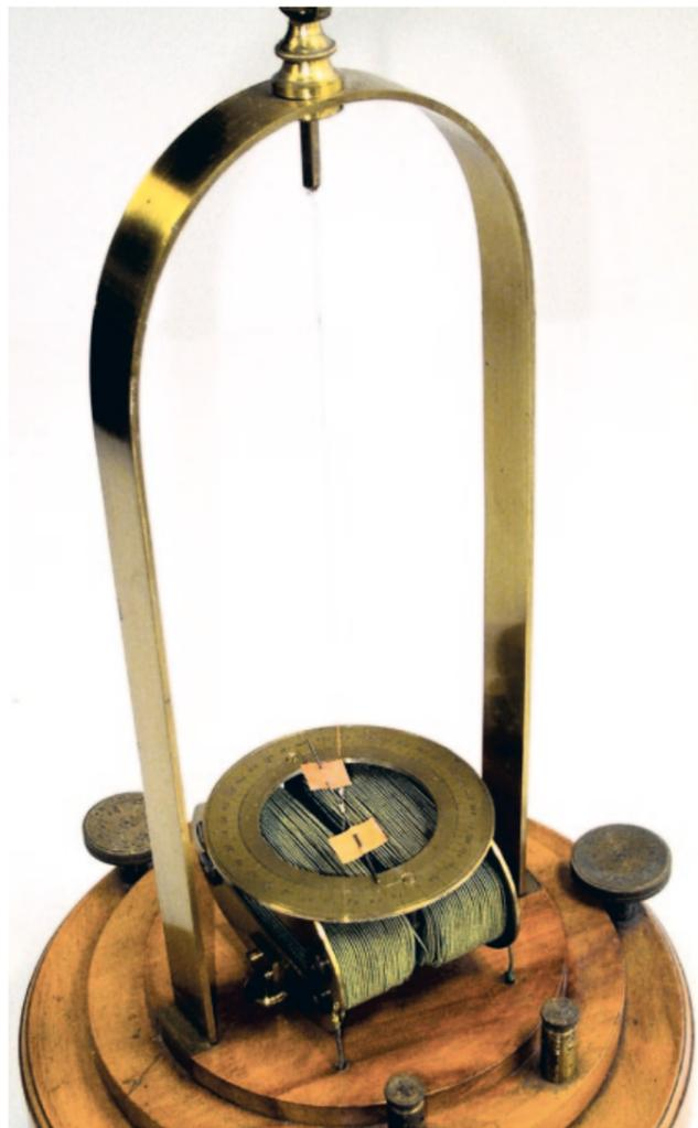
Abb. 39a und 39b: Astaticsches Galvanometer. Zwei Magnetnadeln mit entgegengesetzter Polung, die eine oberhalb und die zweite innerhalb der Spule (genannt *Multiplikator*) hängen an einem Torsionsfaden. Ein durch die Spule fließender Strom läßt sich damit messen. Er lenkt das Nadelsystem aus seiner Ruhelage ab. Das Magnetfeld der Erde hat bei dieser Anordnung keinen Einfluß. Vor 1870.
