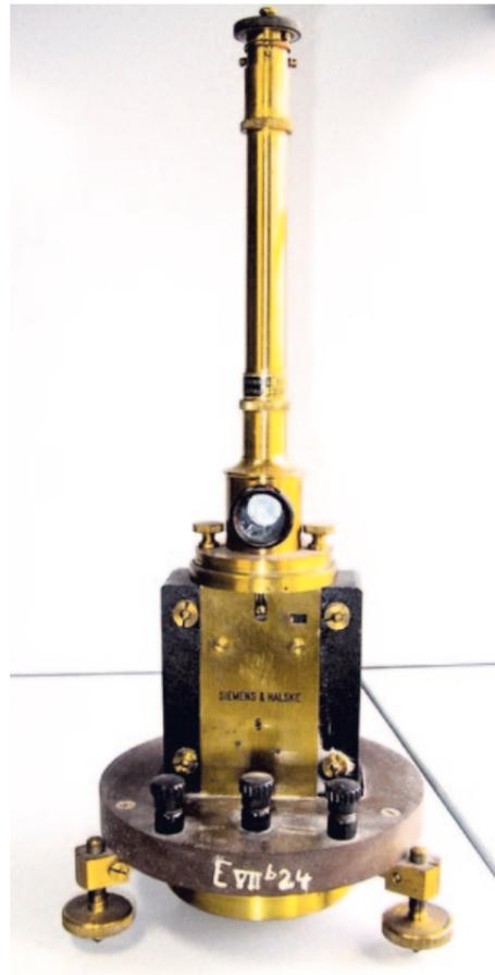
Abb. 45: Spiegelgalvanometer. Eine Spule mit Spiegel für einen Lichtzeiger hängt an einem Torsionsfaden in einem Magnetfeld. Schon ein geringer Strom durch die Spule bewirkt ein Drehmoment, dessen Größe an der Stellung des Spiegels abzulesen ist. Systemwiderstand  $300 \Omega$ , Gesamtwiderstand  $10\,000 \Omega$ . Siemens & Halske, Nr. 1657094.
