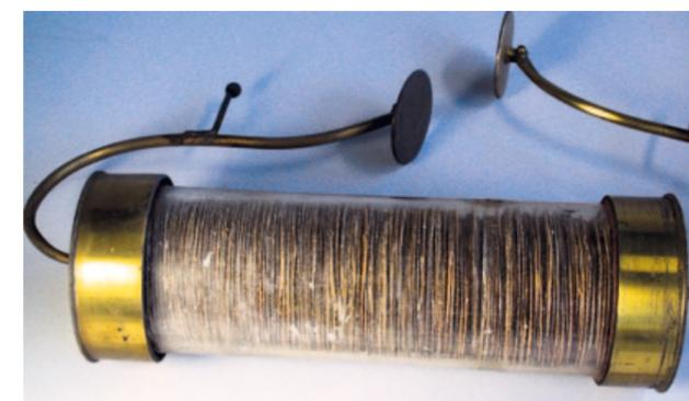
Abb. 36: Zamboni-Säule (langlebige Spannungsquelle). 19. Jahrhundert.
