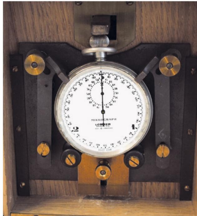
Abb. 16: Stoppuhr mit elektromechanischer Auslösung, 1/100 Sekunde. Mikrograph, Löbner, Berlin.
