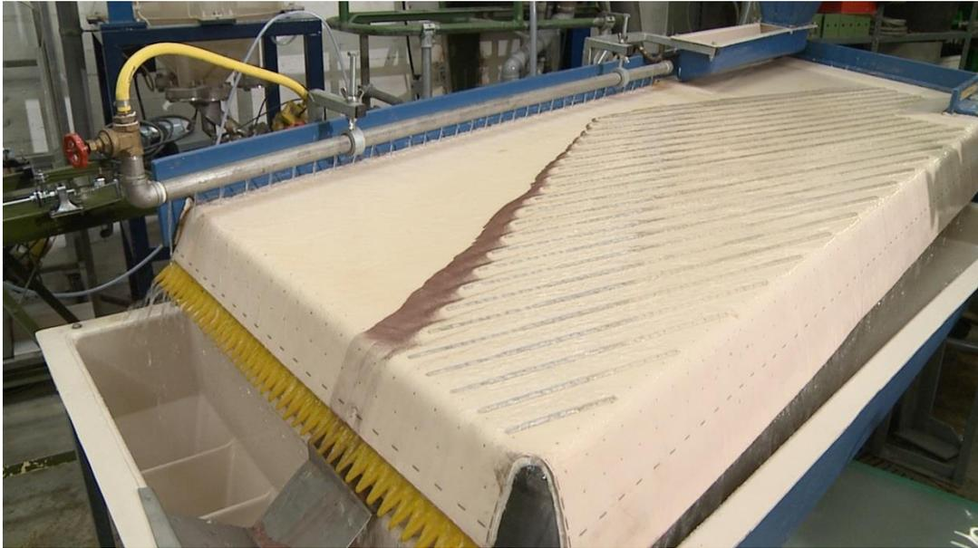
Abbildung 6 Dichtentrennung im wässrigen Medium für Feinstpartikel.
