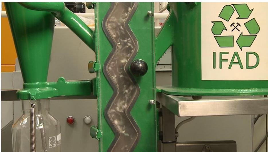
Abbildung 17 Zick-Zack-Sichter zur Trennung von Schwer- und Leichtgut.
