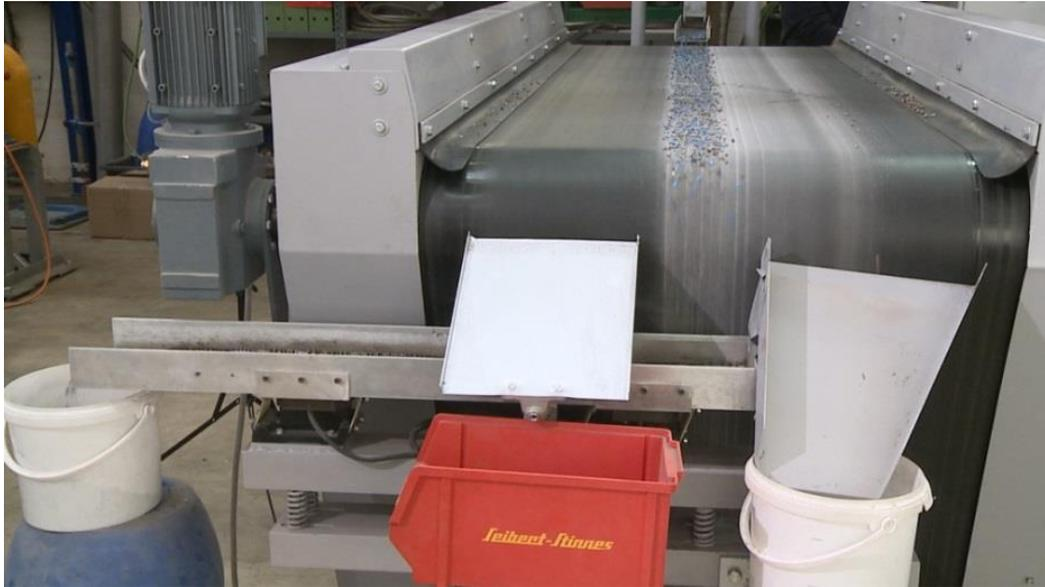
Abbildung 3 Filmsequenz zum optimierten Wirbelstromabscheider.
