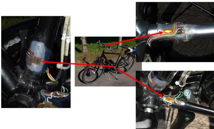
**Abbildung 14 Messstellen am Fahrrad**
