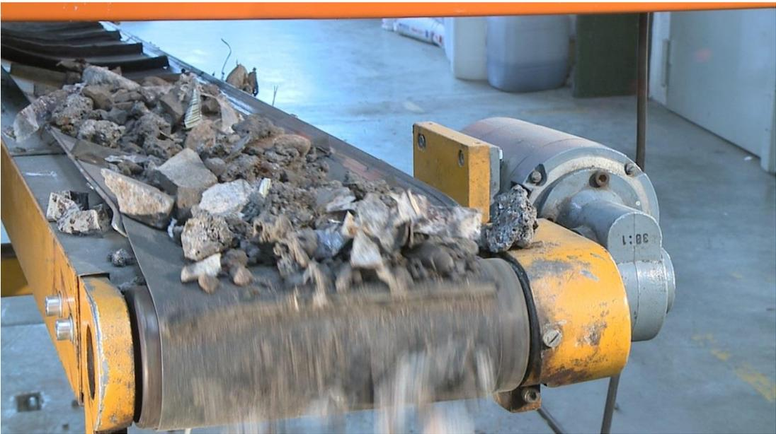
Abbildung 5 Filmsequenz eines Überbandmagneten
