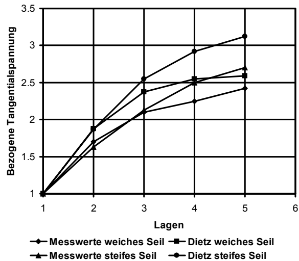
Bild 4: Vergleich analytischer Werte der Dietz Theorie mit aus Messungen erhaltenen Werten
