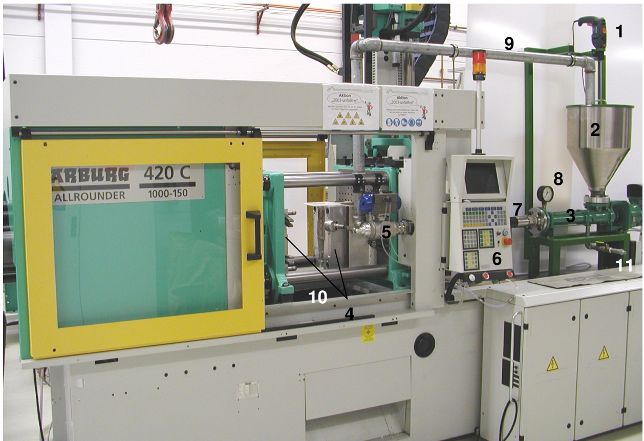
Abbildung 10: Aufbau der Papierspritzguss-Anlage [15] (Beschreibung siehe Text).
