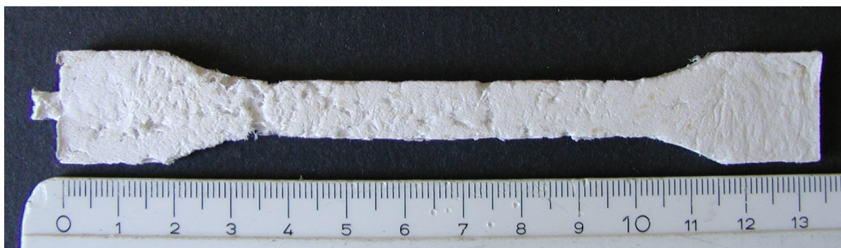
Abbildung 15: Spritzgegossener Zugprüfstab aus Papierfasern [17]
