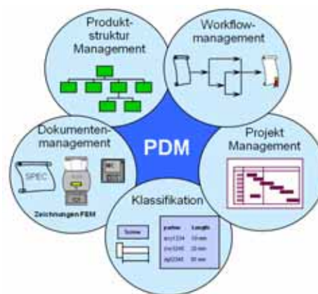
Bild 2: Die Funktionen eines PDM-Systems im Überblick
