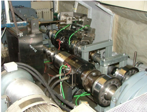
Bild 1: Gelenkwellenprüfstand nach Umbau
