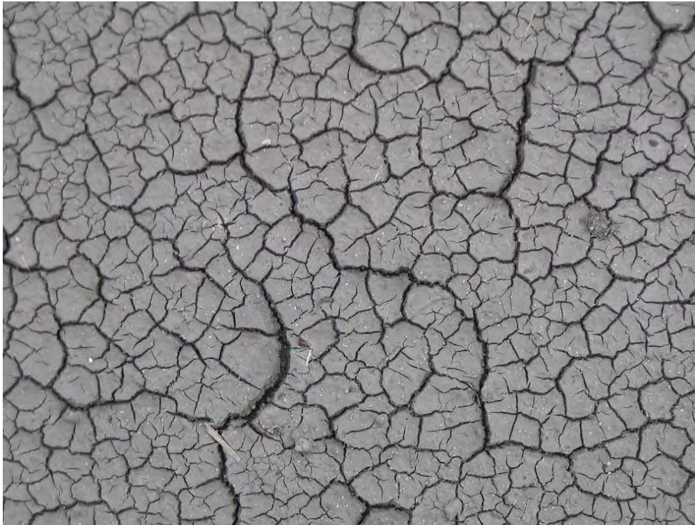
Abbildung 4.21: Fraktale Struktur einer durch Schrumpfungsphänomene eingerissenen Oberfläche [Flickr].
