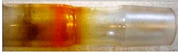
Abb. 3-39 Orangebraune PN-Ablagerungen am Reaktionsrohr.
