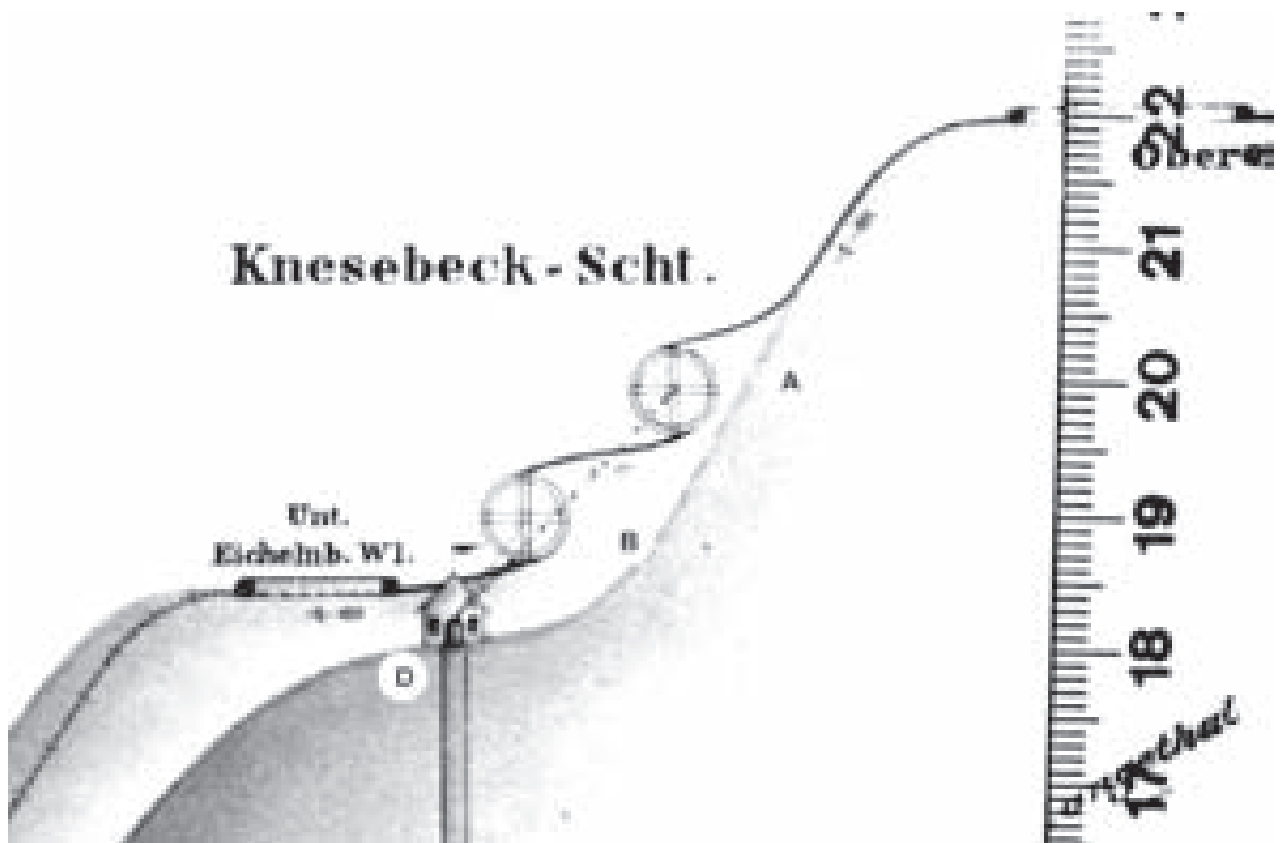
Abb. 40: Anordnung der Wasserräder am Knesebeck-Schacht, 1895 (Sandkuhl [Z71], OBA Rißarchiv).
