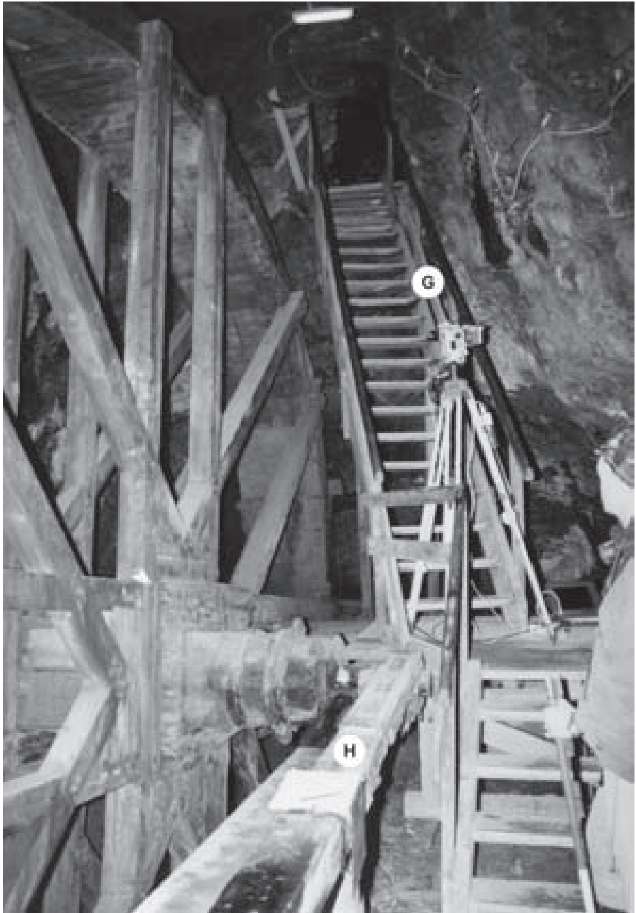
Abb. 91: Serenissimum Kunstrad mit Kurbelzapfen und Gestänge. Aufbau für computergestützte Vermessung.
