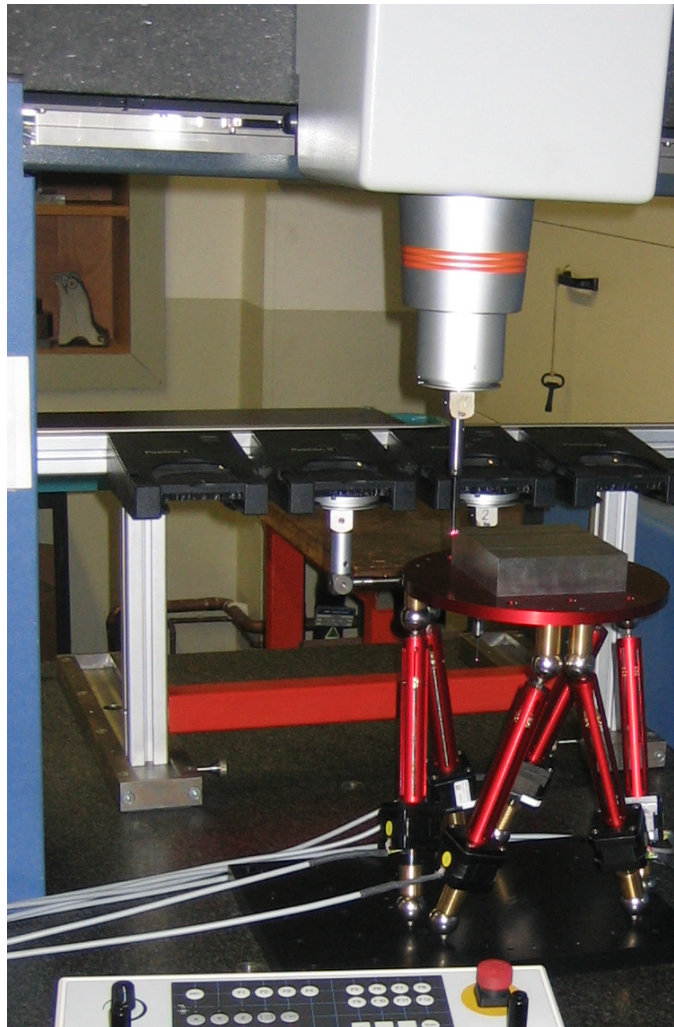
Abbildung 8.9: Antastung des Messquaders auf dem Koordinatenmessgerät des Instituts für Maschinenwesen der TU Clausthal
