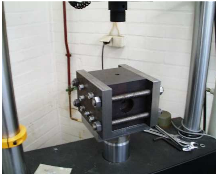
Abbildung 3.2: ECAP-Matrize, eingebaut in Universalprüfmaschine.
