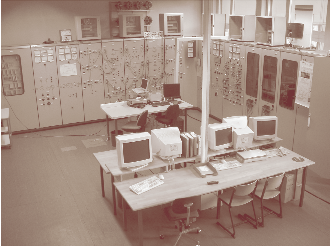
Abb. 5-4 Netz- und Kraftwerkssimulator (NuK) des Labors für Elektrische Energieversorgung der FH-OOW (Status Oktober 2006)
