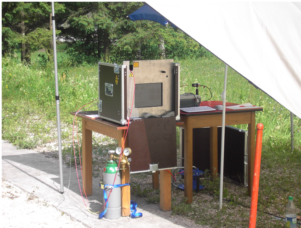
Abbildung 5.13: LIBS-Minensuchnadel im Feldtest.
