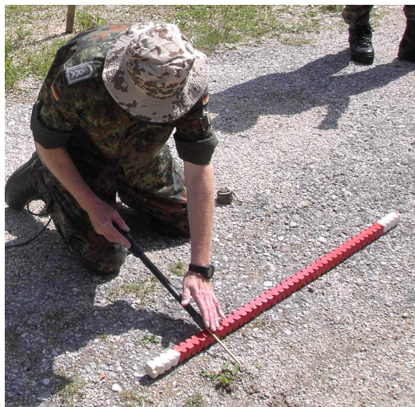
Abbildung 5.2: Minensuche mittels konventioneller Minensuchnadel.
