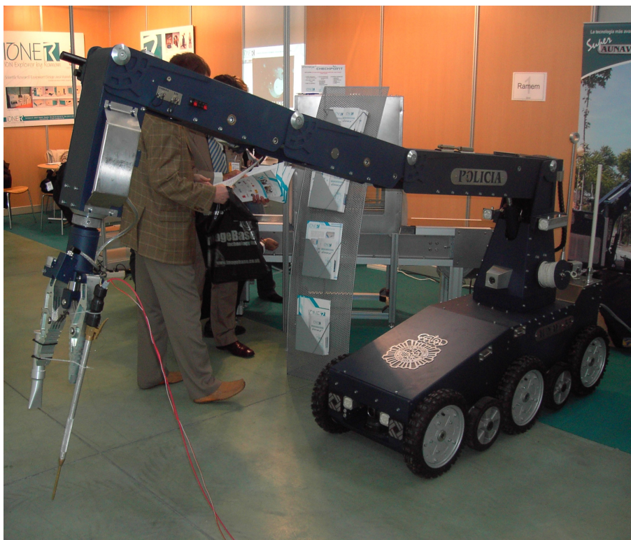
Abbildung 5.18: LIBS-Minensuchnadel befestigt am Arm eines Polizeiroboters zur Entschärfung von IED's.
