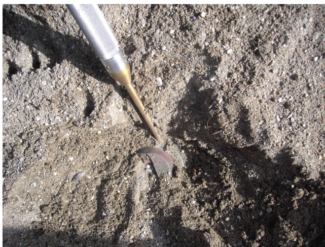
Abbildung 5.15: Messungen an der AP-Mine Typ Maus (hier noch freigelegt).
