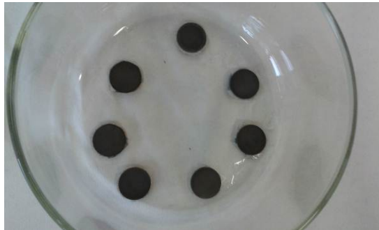
Abbildung 3.11: Mit 8YSZ beschichtete Crofer22APU-Substrate nach dem Aktivierungsschritt (RSE-Milano).
