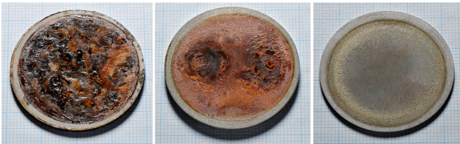
Abbildung 4.60: Substrate nach Auslagerung im Rauchgaskanal von Braunkohle befeuerten Kraftwerk von RWE Niederaußem, 14 Tage bei 68 °C und 100 % rel. Feuchte: a) 1.4760 Crofer22APU, b) 1.4404 316L, c) ITM26 Plansee.
