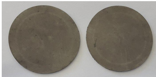
Abbildung 4.55: Mit Pd beschichtete Substrate PdM-D1a3-25-d39-1050-3-8 (links) und PdM-D1a3-25-d39-1050-3-9 (rechts) mittels ELP, RSE, Mailand.
