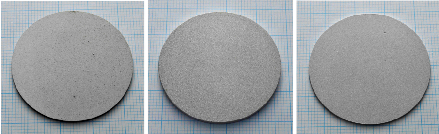
Abbildung 3.1: Substrate für die Auslagerung im Rauchgaskanal des Braunkohle befeuerten Kraftwerks von RWE in Niederaußem: a) 1.4760 (Crofer22APU), b) 1.4404 (316L), c) ITM26 Plansee.
