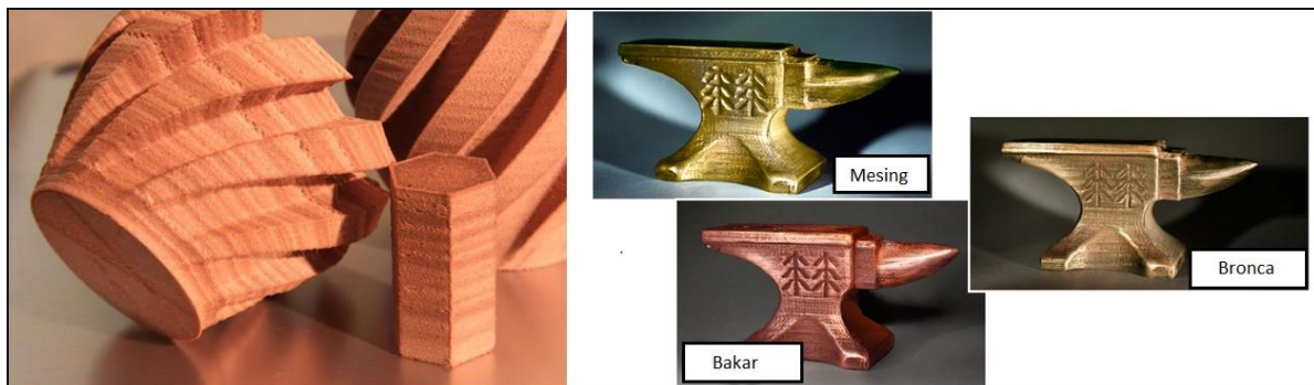
Slika 2.12. Tvorevine izrađene od kompozitnih materijala: a) kompozit PLA/drvo, b) kompozit PLA/metal [14]
