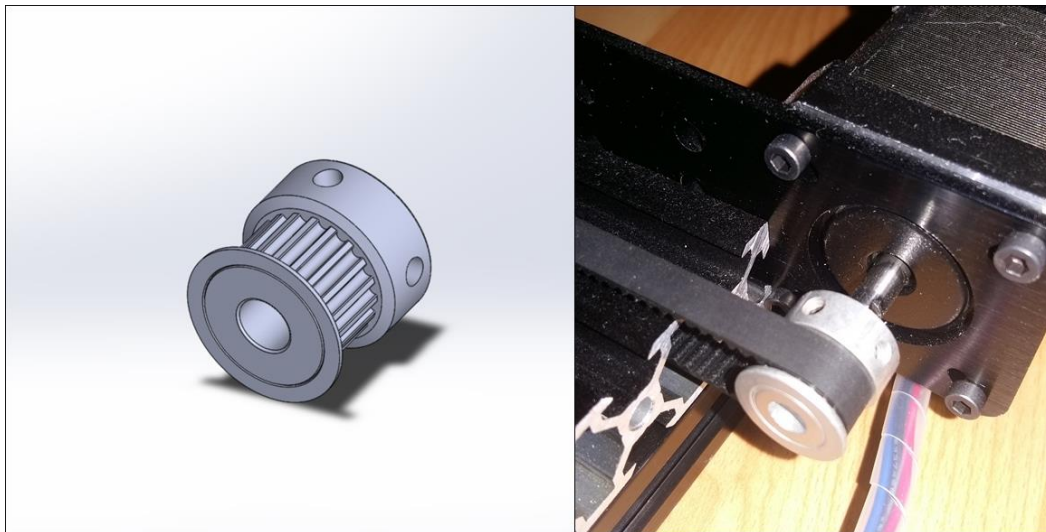
Slika 3.2. Pogonska remenica: a) 3D model pogonske remenice, b) prikaz montaže na stroju
