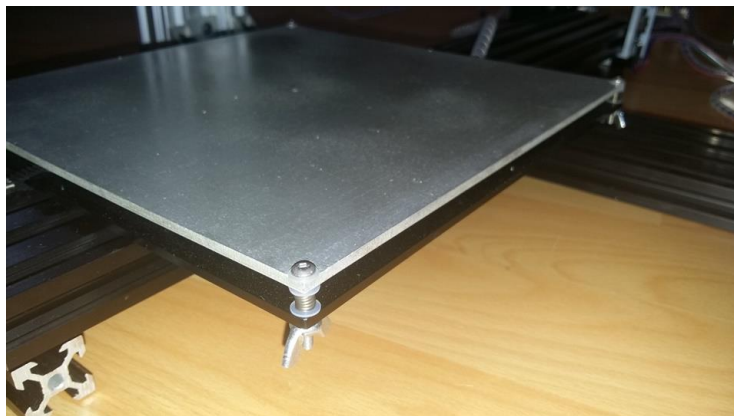
Slika 3.11. Gornja ploča radne podloge s oprugom i vijkom za namještanje visine
