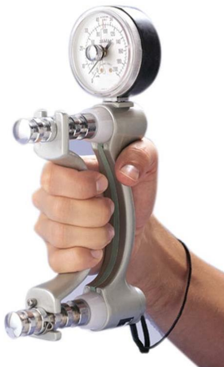
Slika 19. Mjerenje snage stiska hidrauličnim dinamometrom [18]
