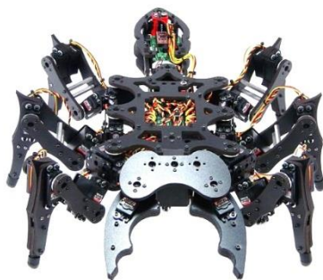
Slika 44. Hexapod temeljen na Arduino čipu [45]
