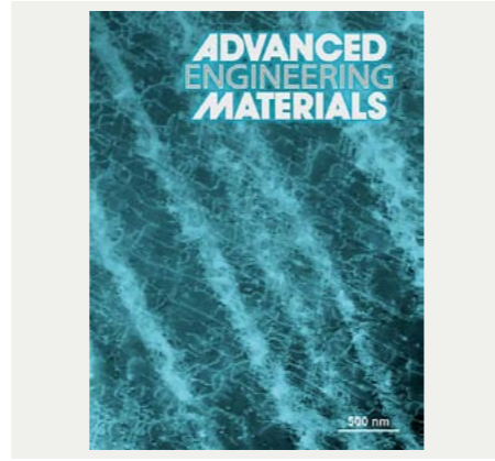
Titelbild der 'Advanced Engineering Materials' einer transmissionselektronenmikroskopischen Aufnahme von Inconel 718, hergestellt mittels selektivem Laserschmelzen
