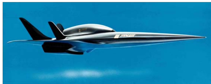
In dem von 1989 - 2003 geförderten Sonderforschungsbereich „SFB 255: Transatmosphärische Flugsysteme - Grundlagen der Aerothermodynamik, Antriebe und Flugmechanik“ (Sprecher: G. Sachs, TU München) wurde u.a. ein detailliertes mathematisches Modell eines nach dem Raumfahrt-pionier Eugen Sänger benannten zweistufigen, horizontal startenden und landenden Raumtransporters entwickelt, dessen Unterstufe mit ihrem Ramjet-Scramjet-Triebwerk als Basis für das verwendete Modell eines hypersonischen Passagierflugzeugs diente.
