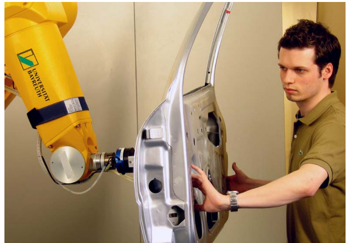
Sichere Mensch/Roboter-Kooperation durch autonome, kollisionsfreie Roboterbewegungen bei Hol- und Bringdiensten (Bild links) oder durch Halten von schweren Werkstücken mit Führung des Roboters durch den Menschen (rechts)
