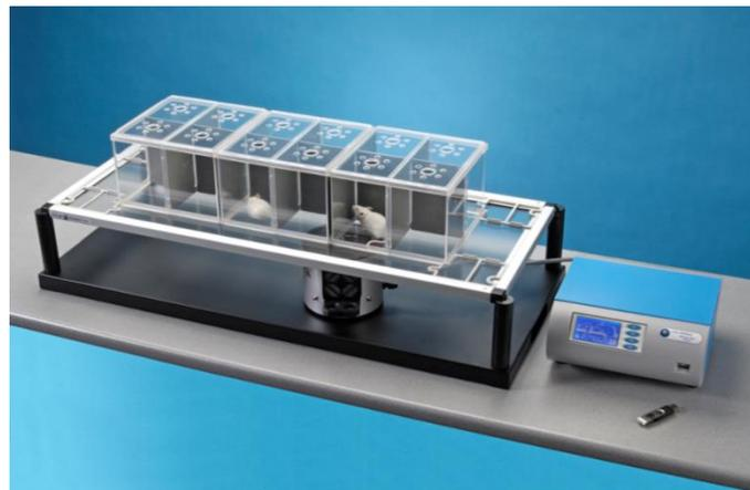
**Abb. 12 Aufbau zur Testung der Hitze-Hyperalgesie.** Die Testung der Hitze-Hyperalgesie erfolgte mit Hilfe der sogenannten „Hot-Plate“ (Hargreaves-Testung). Hierbei befinden sich die Tiere in einer Plastikbox auf einer Plexiglasscheibe. Unter ihnen befindet sich die Hitze-Quelle, welche mittig unter das letzte Drittel der Pfote platziert wird. (Quelle: Ugobasile, Italien).
