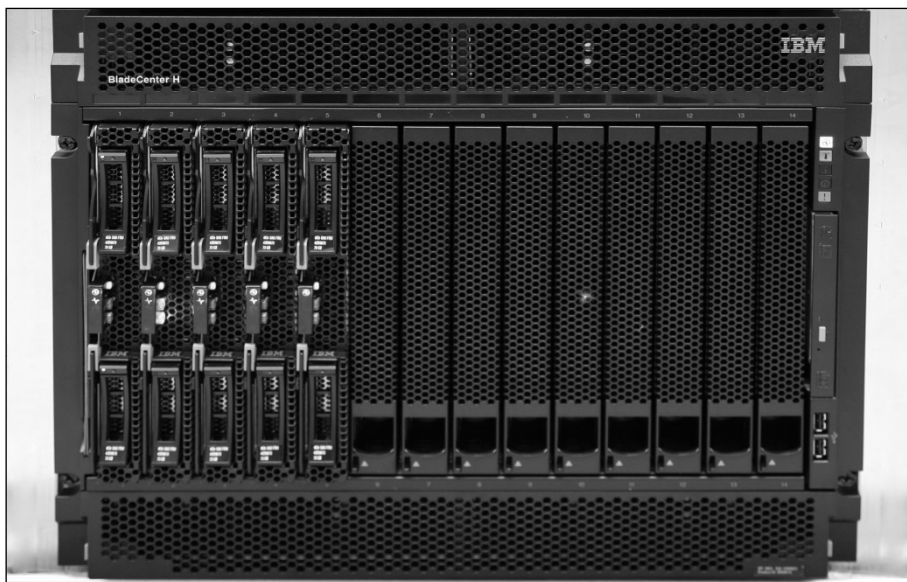
Abbildung 2-27: Blade Chassis, bestückt mit fünf Blade Servern
