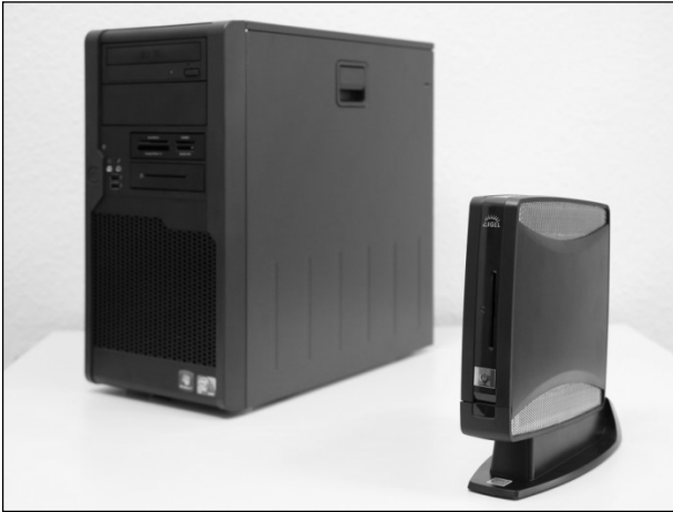
Abbildung 2-26: Personal Computer (links) und Thin Client (rechts)
