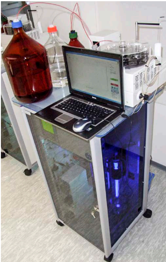
Abbildung 9: Flüssigchromatograph der Firma Huber zur Trennung gelöster organischer Verbindungen (LC-OCD-OND).
