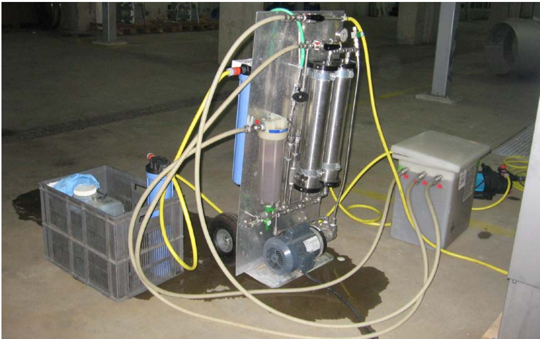
Abbildung 4: Modifiziertes RealSoft PROS reverse Osmose System zur Anreicherung von hochmolekularen organischen Verbindungen (insbesondere Huminstoffen) aus verschiedenen Gewässern.
