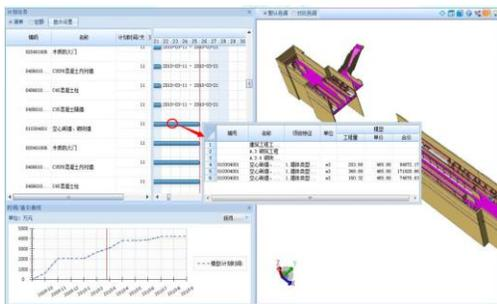
图 14 BIM 模型算量
