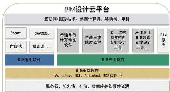
图 1 设计云平台体系架构
