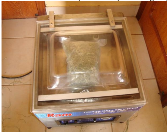
Figura 2 - Máquina seladora a vácuo utilizada para confecção da silagem pré-secada de Tifton-85.
