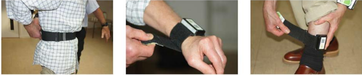
Abbildung 4: Inertial Measurement Units (IMUs) für Bewegungsmessungen im häuslichen Umfeld von Hasomed 4
