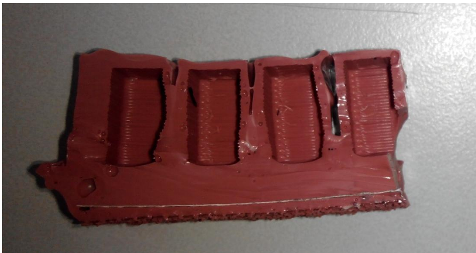
Figura 6.1: Burbujas interiores en el actuador.
