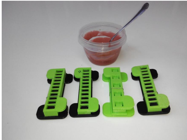
Figura 5.2: Preparar el Elastosil y los moldes.
