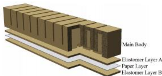
Figura 2.4: “PheuNetBending Actuador”[37].(a) “Main Body”. (b) “Elastomer Layer A”. (c) “Paper Layer”. (d) “Elastomer Layer B” [49].
