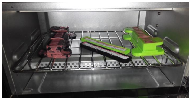
Figura 5.6: Introducir moldes en el horno durante 10 minutos.
