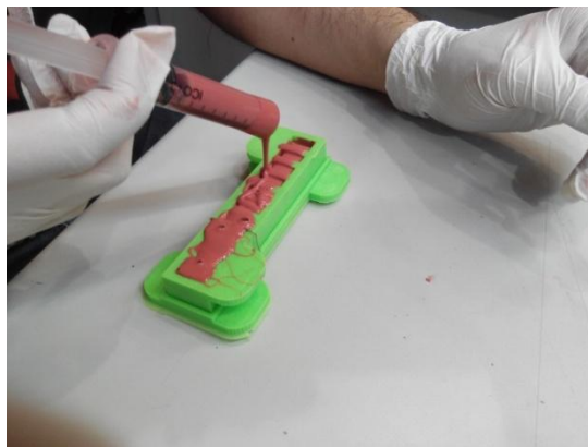
Figura 5.3: Rellenar el molde principal de Elastosil.
