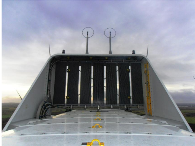
Figura 50 - Anemómetros de resonancia situados en góndola, visión general
