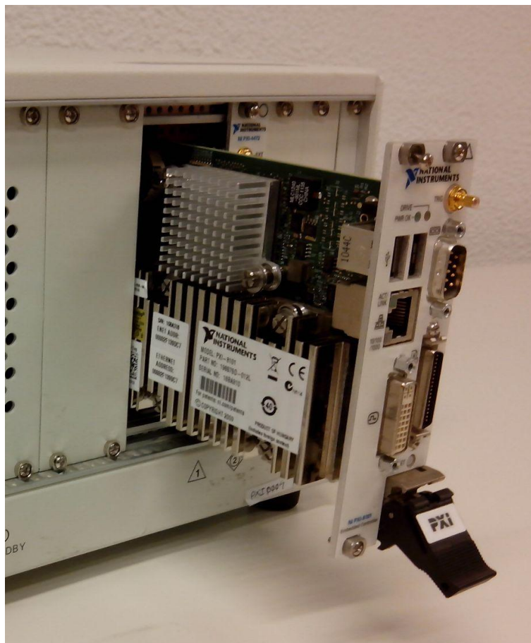
Figura 46 - Controlador PXI-8101, montaje sobre chasis
