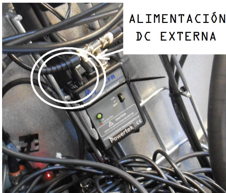
Figura 39 - Integrador con entrada de alimentación externa
