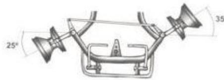
Fig5: Esquema del tren delantero de un kart mostrando el efecto Ackerman
