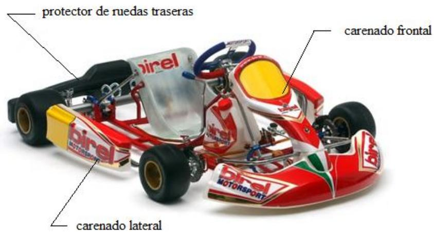
Fig\_19: Carenados de un kart [3]
