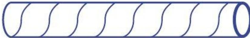
Fig\_123: Tubo con soldadura helicoidal
