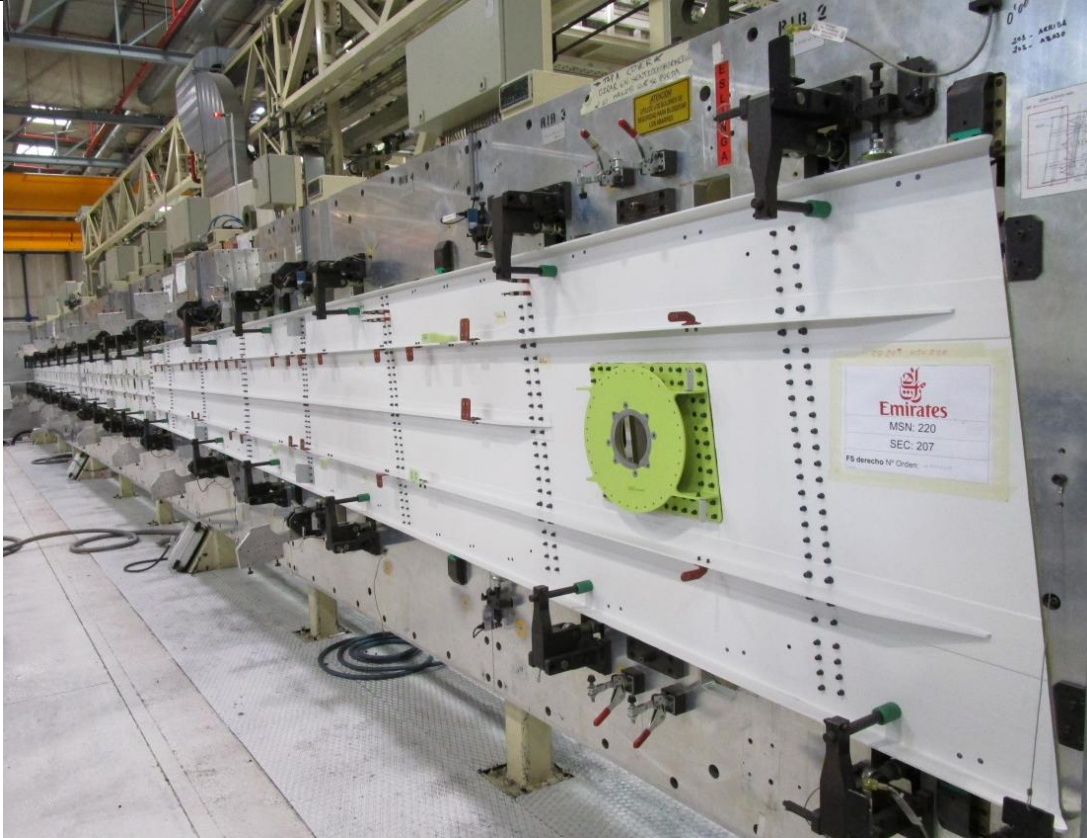
Figura 31. Largo FS listo para sacarlo de la grada
