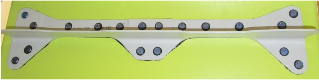
Figura 28. Sellante de interposición entre el perfil metálico y el larguero de fibra.
