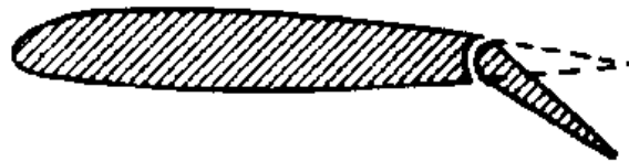
Figura 12. Sección transversal de un ala con las dos posiciones posibles del flap: recogido o parcialmente desplegado hacia abajo
