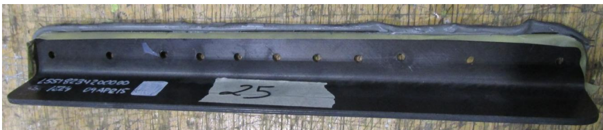
Figura 26. Perfil de fibra con previos y SHIM rebosando en el borde.
