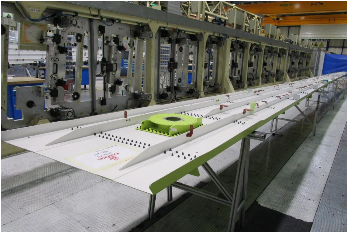
Figura 37. . Larguero RS fuera de grada, sobre las borriquetas
