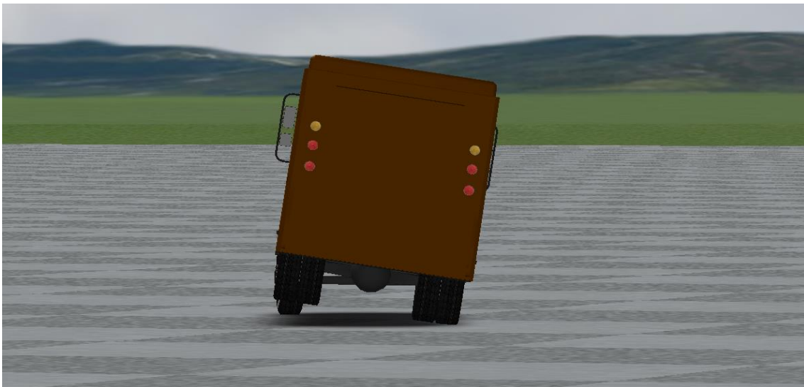
Figura 2.11: Comportamiento del vehículo para valores de transferencia de carga a partir de 1
