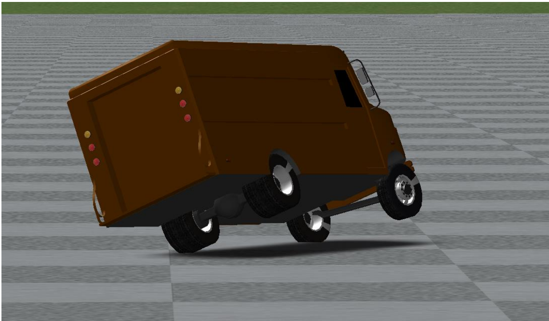
Figura 4.17. Comienzo de vuelco asociado a la pérdida de adherencia rueda calzada en una de las maniobras desechadas
