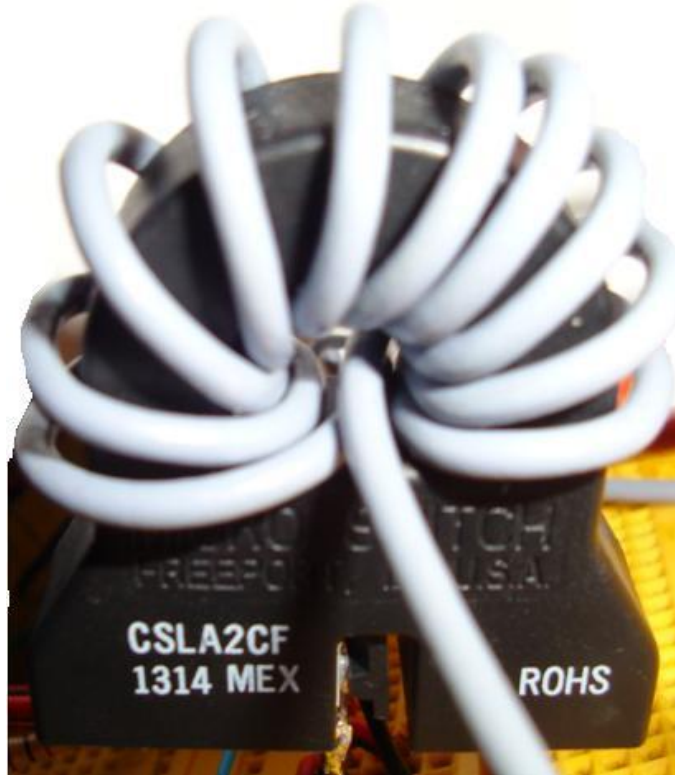
Figura 76. Sensor de corriente CSLA2CF mostrado con 10 vueltas de cable al toroide
