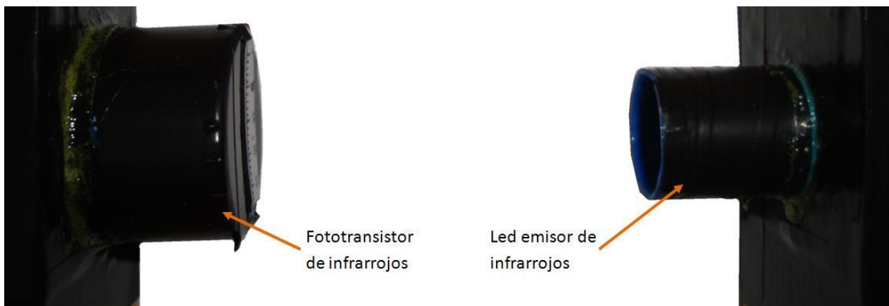
Figura 13. Barrera de IR para la detección de la esfera metálica
