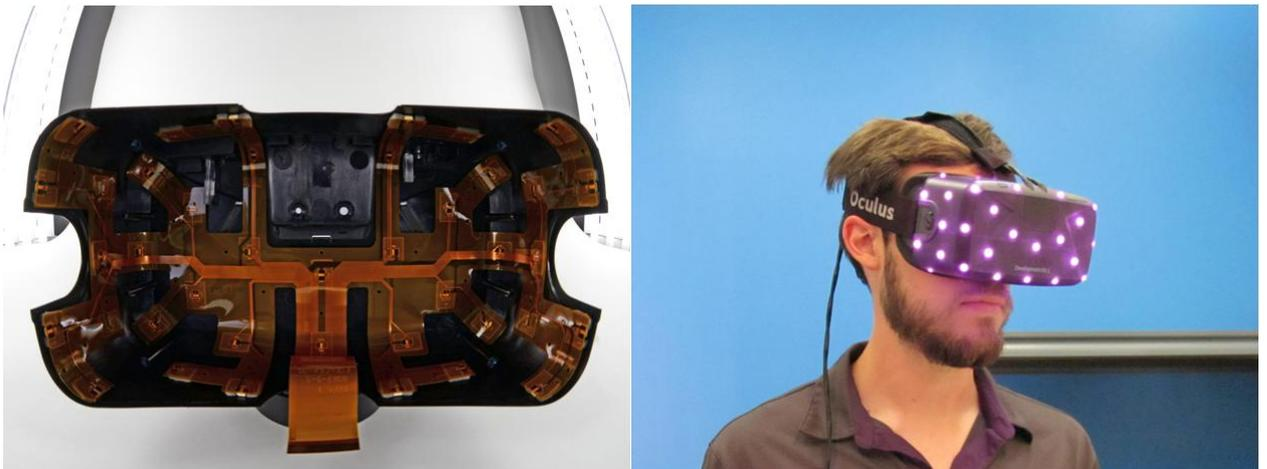
Ilustración 34: Sensores IR Oculus Rift
