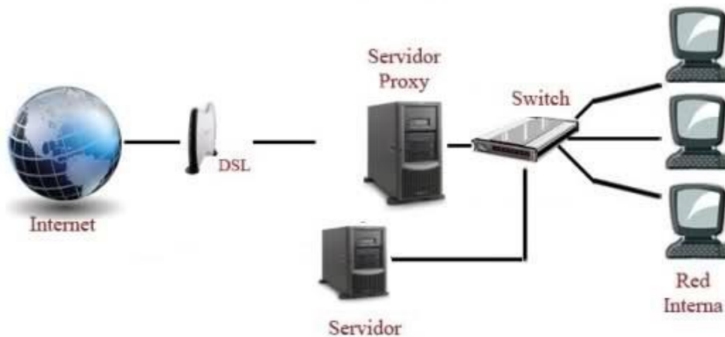
Ilustración 56: Esquema de navegación mediante un servidor Proxy .
