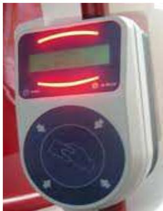
Fig. 10 Sistema de control de acceso tipo validador
