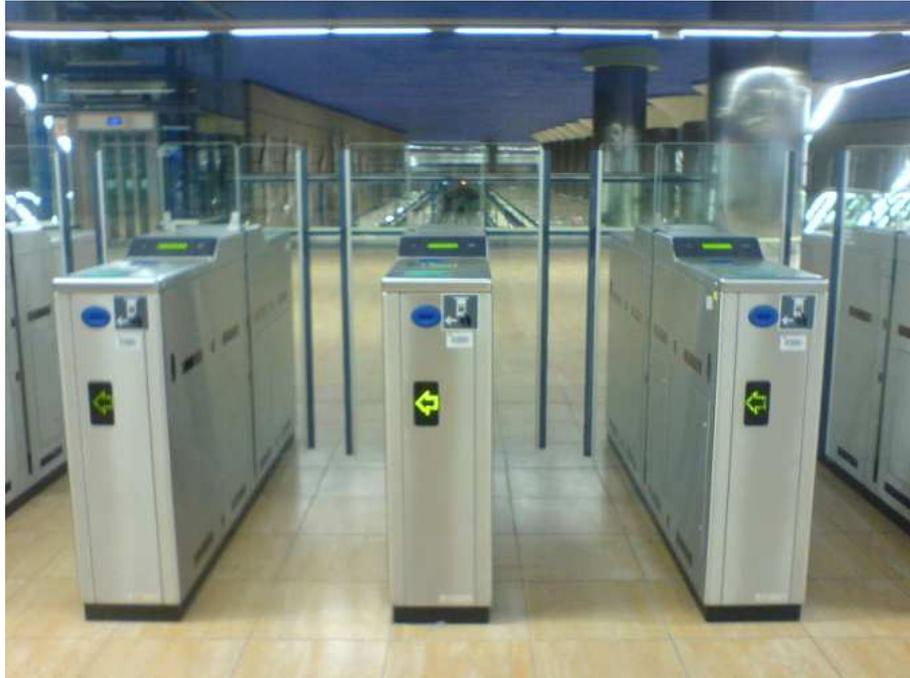
Fig. 9 Batería control de acceso tipo Flap
