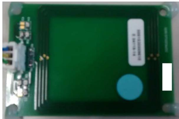
Fig. 23 Antena PCD
