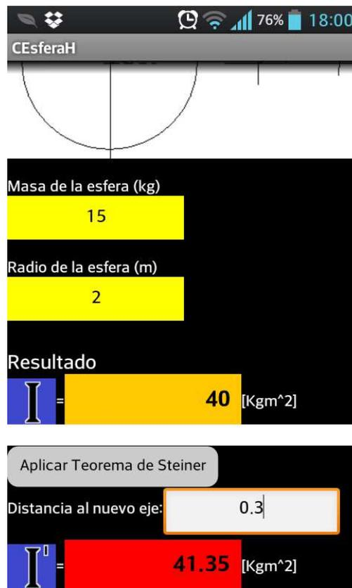
Ilustración 109 - Cálculo de inercia de esfera con Steiner
