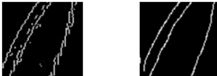
Ilustración 42 - Diferencia operador Sobel y Canny
