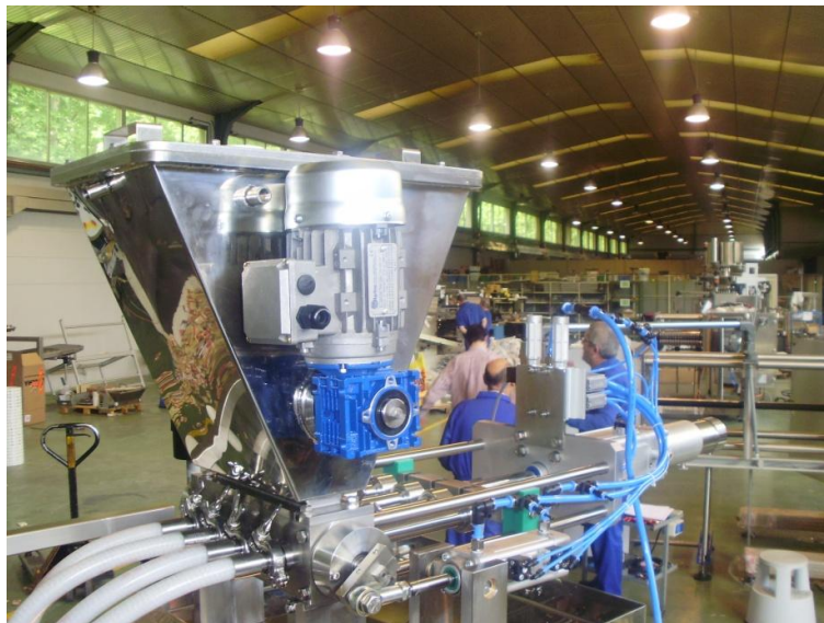
Figura 133. Fotografía de la bomba dosificadora.
