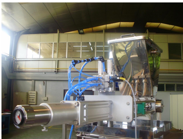
Figura 104. Bomba dosificadora, vista isométrica-trasera.
