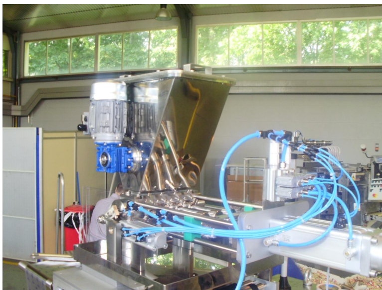
Figura 103. Bomba dosificadora, vista isométrica-trasera.
