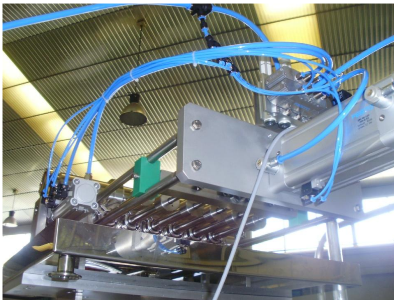
Figura 79. Placa y bandeja de la bomba dosificadora.
