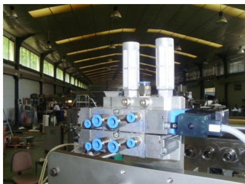
Figura 46. Conjunto de válvulas y silenciadores sin tubos.
