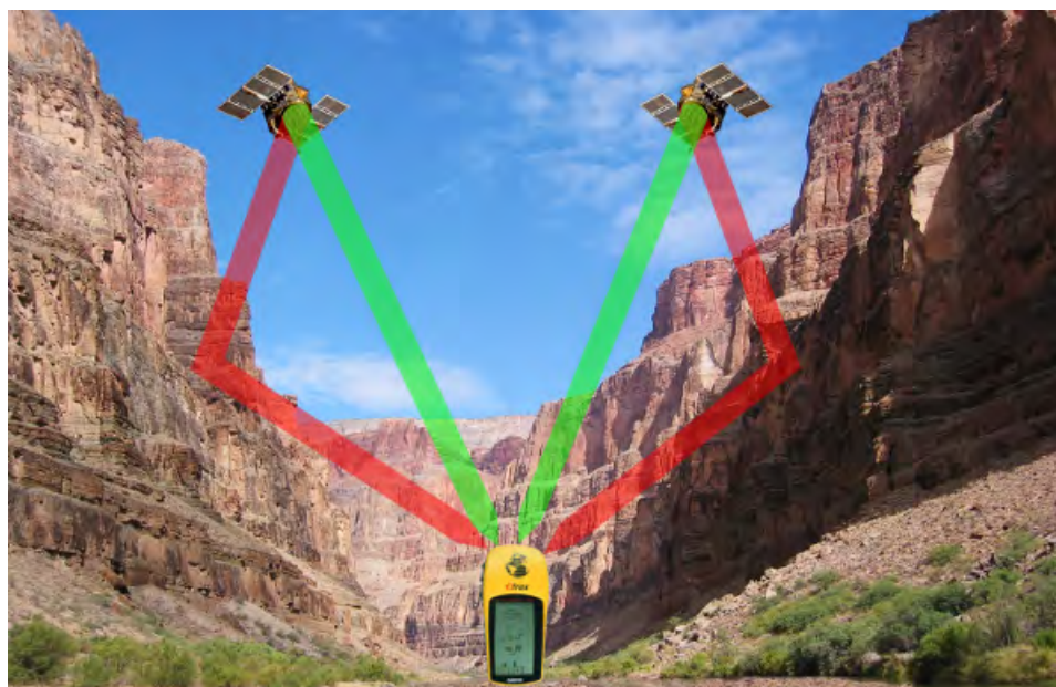
Figura 1.7: Visualización del efecto multitrayectoria
