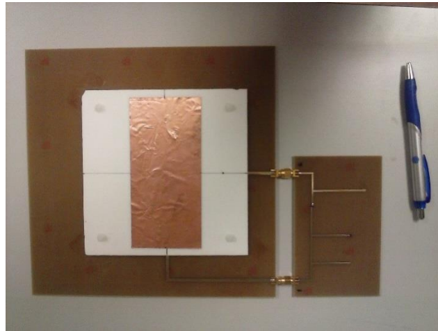
Figura 50. Montaje final de antena y circuito
